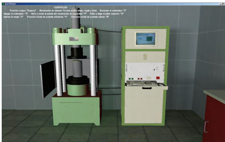
Fig. 2. Simulación de la colocación de la probeta de hormigón en la máquina de compresión SERIE MES 200AV.
