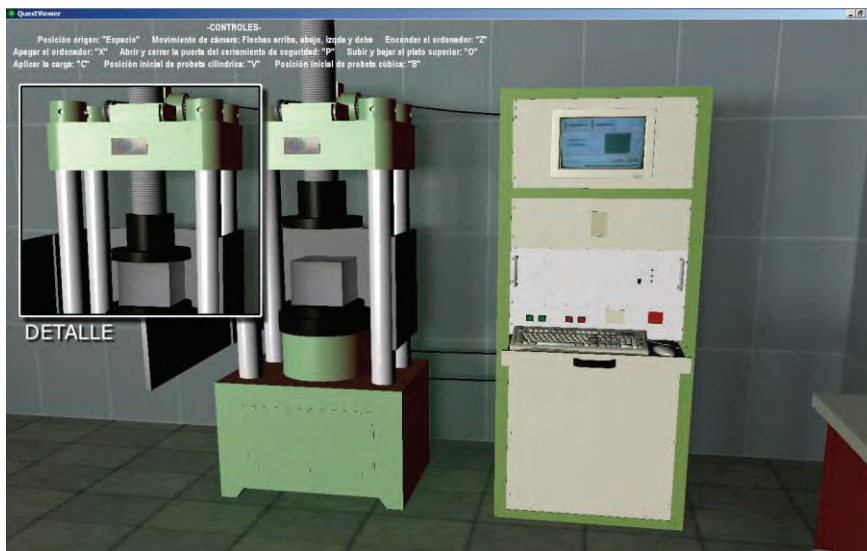
Fig. 6. Movimiento del plato superior en la máquina de compresión (detalle: plato superior posicionado en la posición inicial del ensayo).
