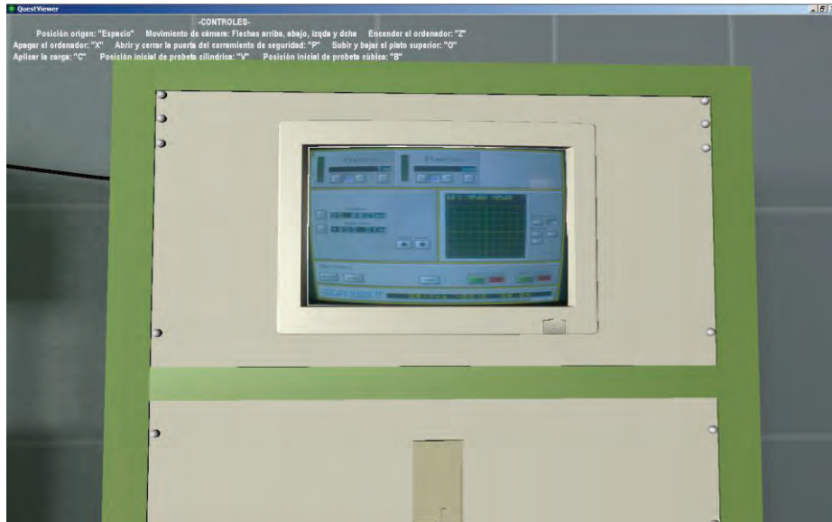
Fig. 3. Simulación del programa de ensayos PCD2K con el que se configuran las cargas del ensayo de compresión.
