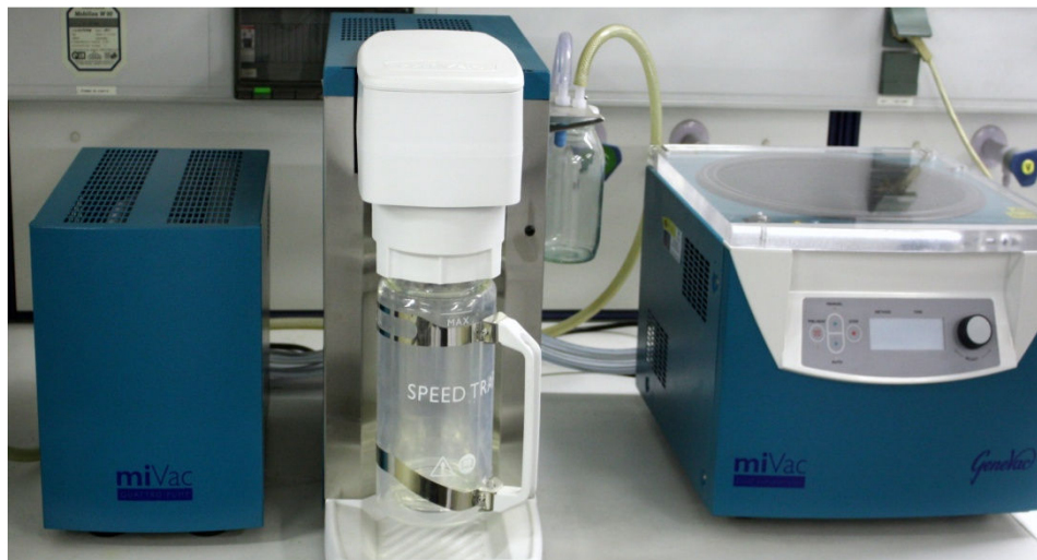
Figura 3.7. Equipo evaporador–concentrador de muestras utilizado en el proceso de purificación de los aductos formados en las reacciones de alquilación
