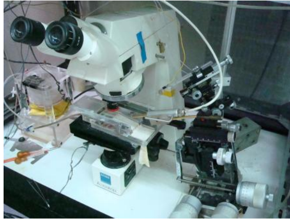
Fig. 7. A. Cámara de registro tipo Interfase. Corresponde con la Unidad BSC-HT, la cual permite mediante el principio de semi-submersión un registro estable de rodajas cerebrales. B. Microscopio Óptico y Cámara de registro. Se evidencia además los micromanipuladores y los electrodos de registro y estimulación.
