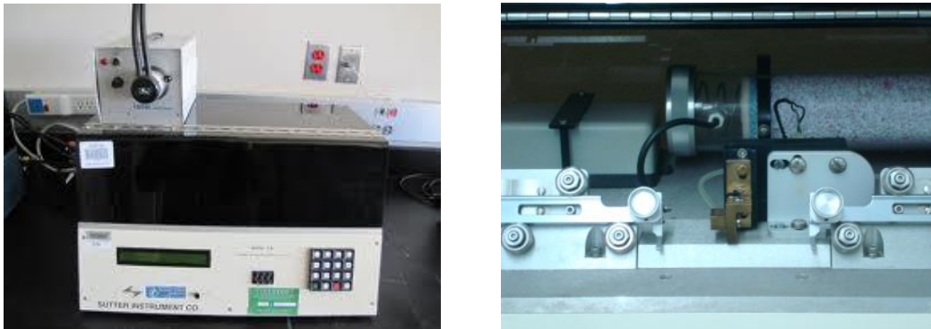
Fig. 8. Estirador de pipetas modelo P87, utilizado para hacer las micropipetas /electrodos de registro. Consiste en un estirador horizontal acoplado a una resistencia.
