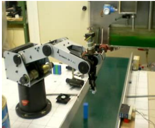
(a) Imagen real del robot Scrobot ER-V Plus durante una tarea típica de pick & place
