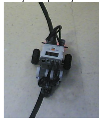
(c) Imagen del robot Lego NXT durante una prueba de seguimiento de líneas
