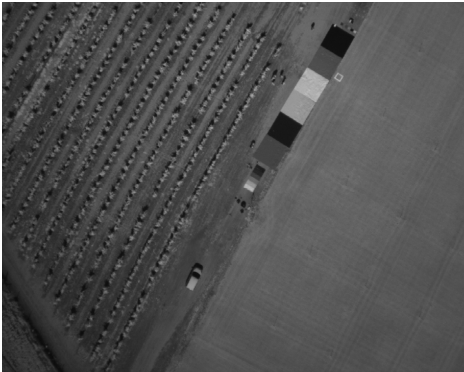
Fig. 22. Ejemplo de imagen multiespectral de 8 bits (canal master, 780nm)
