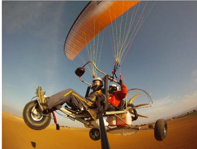
Fig. 5. Plataforma aérea utilizada en este estudio (paramotor)
