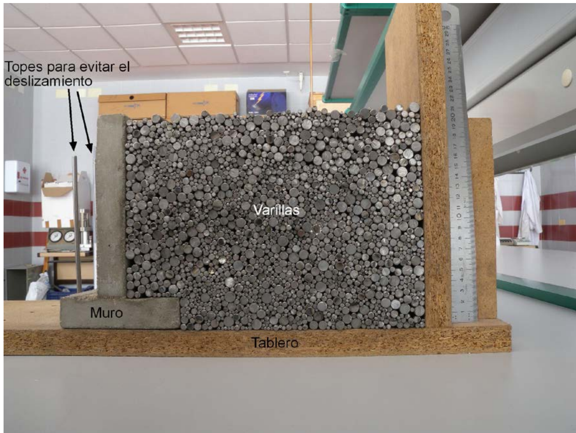
Figura 4. Montaje de la estructura de contención en T invertida.
