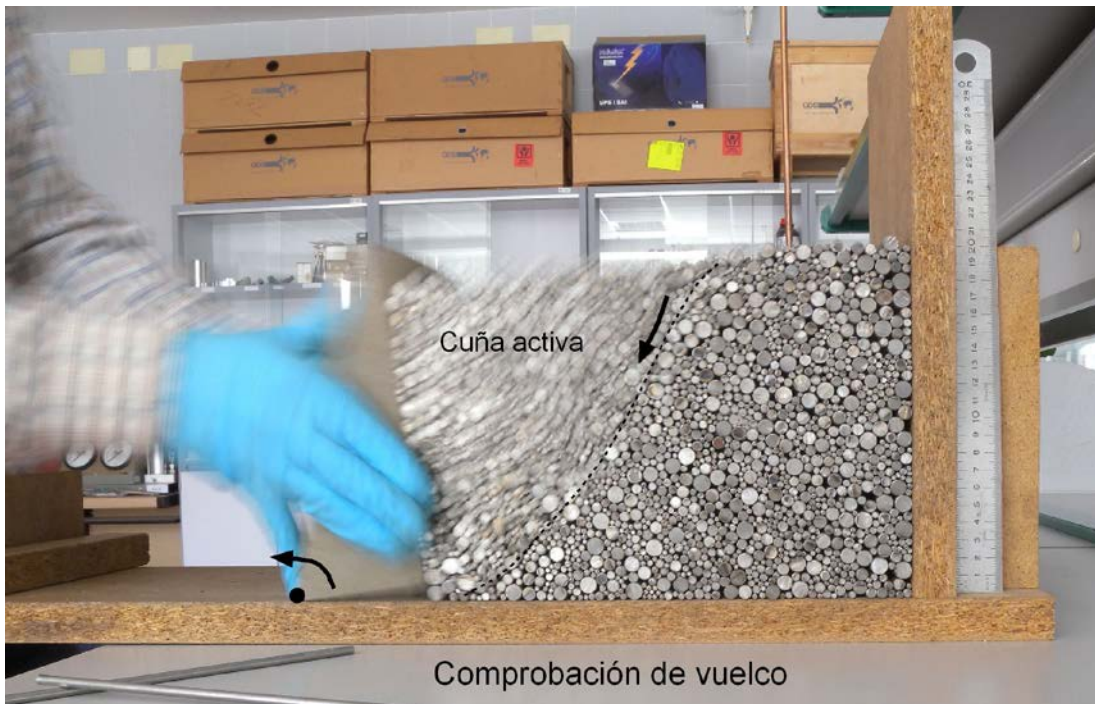
Figura 5. Comprobación del vuelco en el muro de gravedad. Obsérvese la cuña que genera el empuje activo. Imagen tomada con exposición durante 2 segundos para observar el movimiento.
