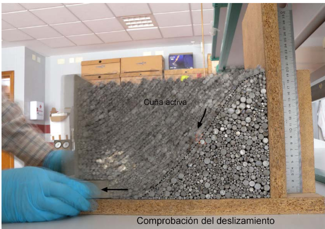
Figura 6. Comprobación de la estabilidad frente al deslizamiento en el muro en T invertida. Imagen tomada con exposición durante 2 segundos para observar el movimiento.
