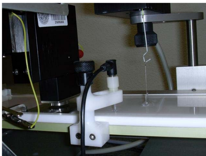
Figura III.12. Fotografía de la sonda Kelvin modelo SPOT 2 de la casa comercial KSV Instrument LTD montado sobre la balanza de Langmuir.
