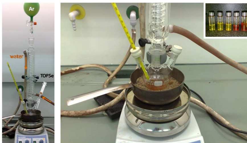
Figura III.4. Fotografías del montaje experimental de la síntesis de QDs. En el recuadro aparecen varios viales que muestran la evolución de la mezcla reaccionante con el tamaño de los cristales, de amarillo (1.8 nm de diámetro) a rojo (3.4 nm de diámetro).
