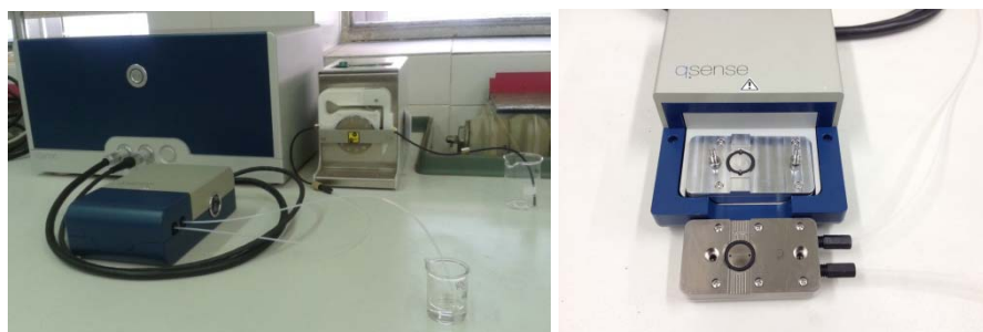
Figura III.27. Fotografías del equipo de Microbalanza de Cristal de Cuarzo Disipativa (QCM-D) (Q-Sense E1, Gothenburg, Sweden).
