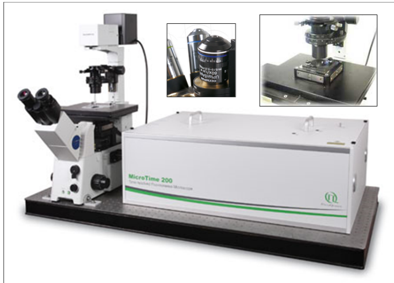
Figura III.24. Fotografía de la unidad óptica (MicroTime 200, PicoQuant) unida al microscopio Olympus. Zoom del objetivo y del porta muestras.
