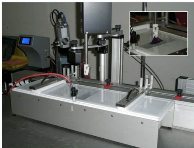
Figura III.10. Balanza Langmuir-Blodgett modelo Standard (KSV Instruments). En el recuadro se muestra el brazo dipper que sostiene el sustrato durante la deposición LB.
