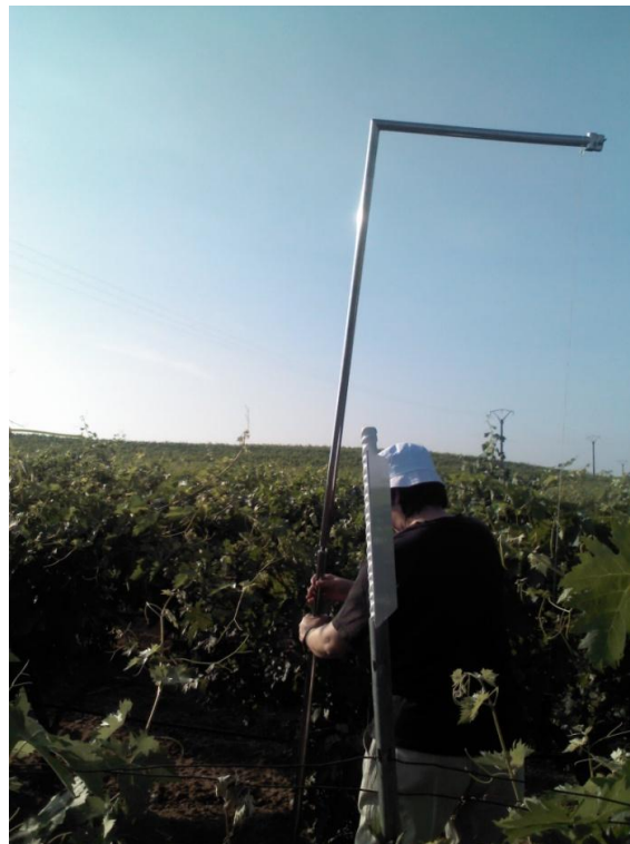
Figura 35. Procedimiento de la medida con el espectrorradiómetro Ocean Optics USB4000.
