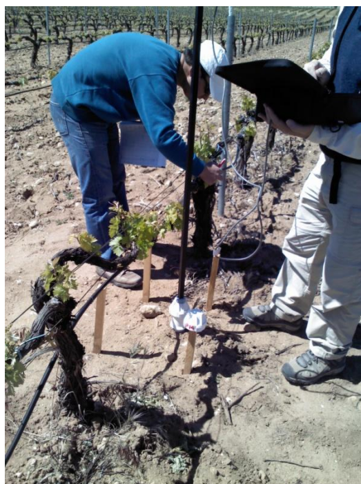
Figura 30. Utilización de la sonda FDR en la zona de estudio.
