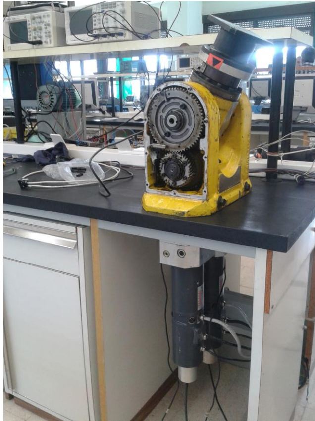
Ilustración 17 - Localización de motores de los ejes 5 y 6 (muñeca).
