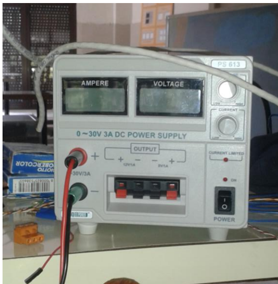
Ilustración 61 - Fuente de alimentación externa de los sensores inductivos.
