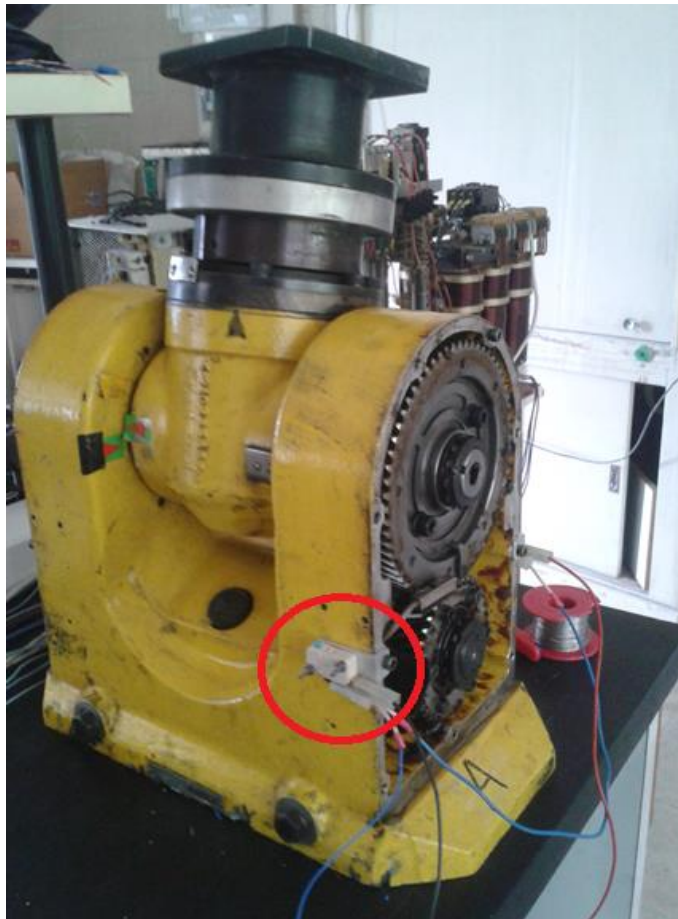
Ilustración 64 - Posición de los sensores finales de carrera en la muñeca del robot.
