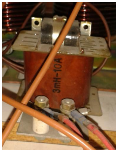
Ilustración 18 - Bobina externa conectada al inducido de los motores.
