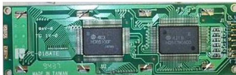
Ilustración 163 - Vista trasera del display LCD. Controlador HD44780 incrustado.
