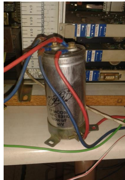
Ilustración 22 – Transformador monofásico y rectificador para alimentación de frenos. Condensador del filtro capacitivo.
