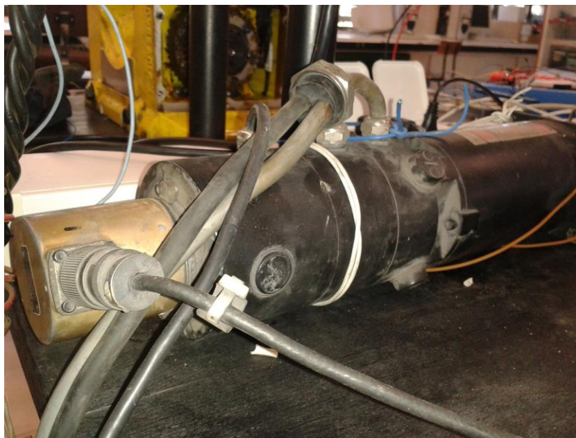
Ilustración 15 - Motores de los ejes 5 y 6. Detalle de la parte trasera.
