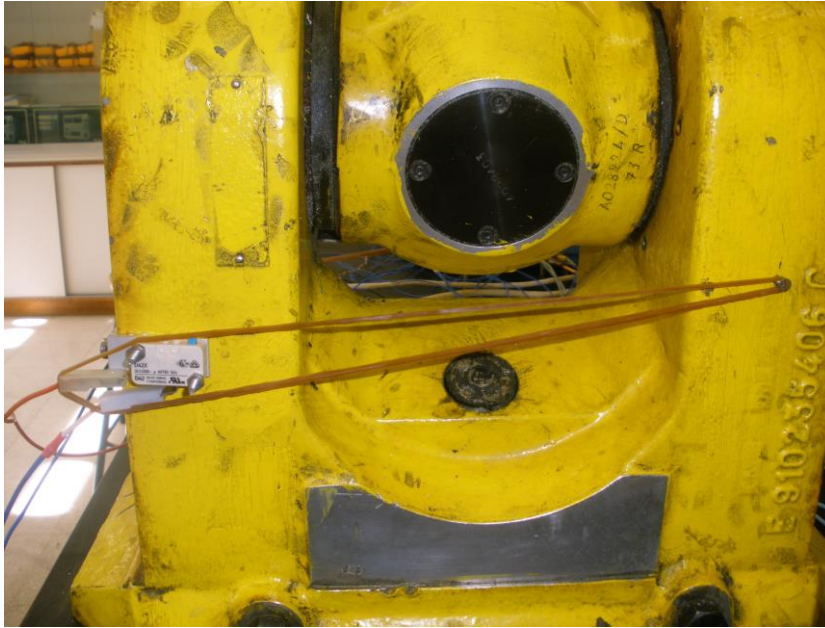
Ilustración 63 - Montaje del sensor final de carrera de la muñeca del robot.
