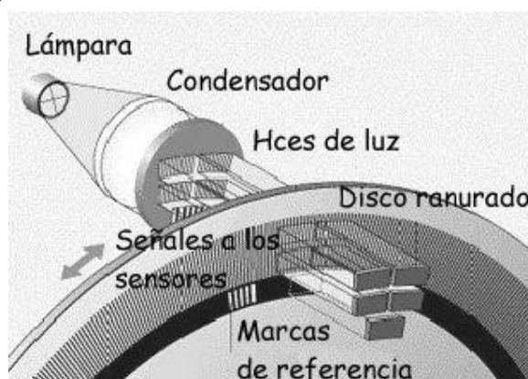
Ilustración 39 - Esquema de funcionamiento del codificador angular de posición encoder.
