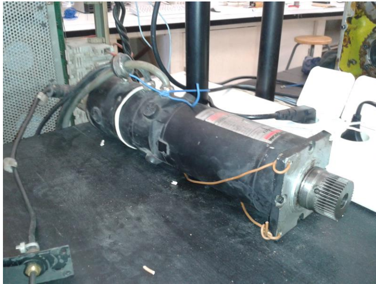
Ilustración 14 - Motores de los ejes 5 y 6.
