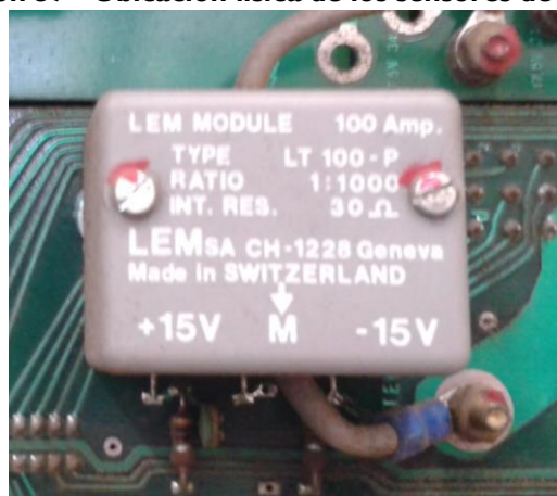
Ilustración 38 - Detalle sensor de corriente.
