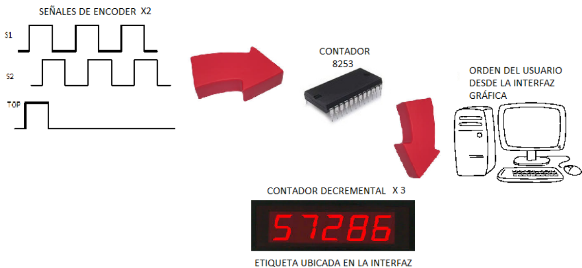
Ilustración 222 - Esquema de conteo mediante contadores 8253.
