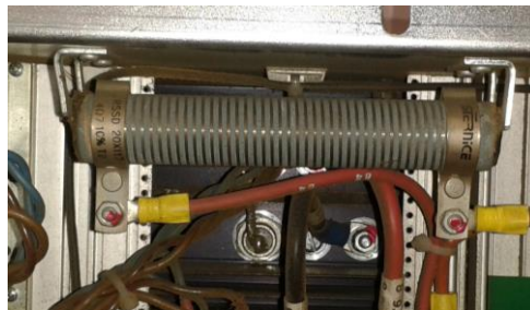
Ilustración 86 - Resistencia en serie con el filtro capacitivo
