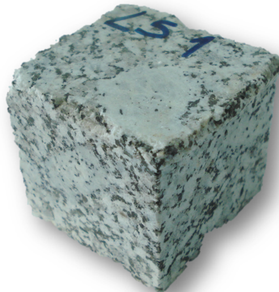
Figura 3.48. Aspecto de visu del granito de Los Santos en una de las probetas empleadas para la caracterización del material.
