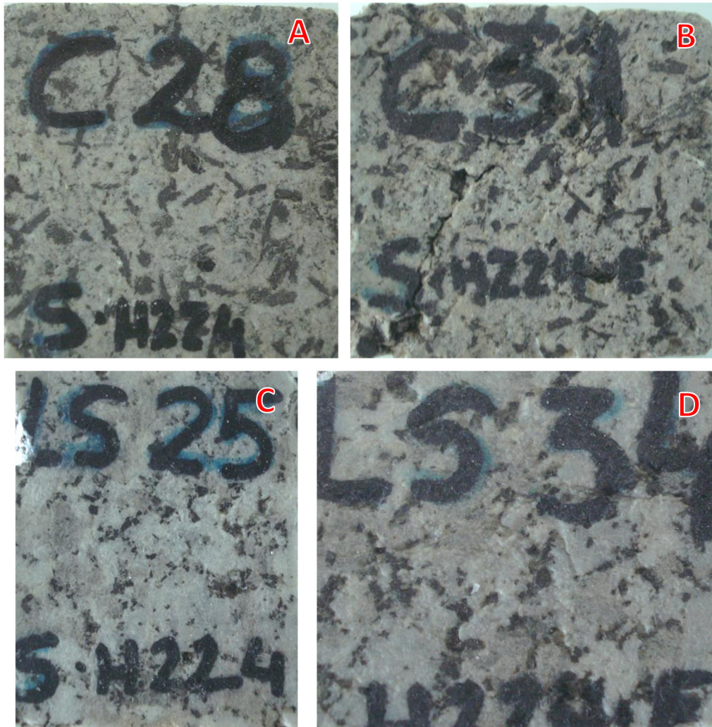
Figura 5.44. Probetas CS tratadas con H224 (A y C) y después envejecidas por HD (B y D) de Calzadilla y Los Santos, respectivamente.
