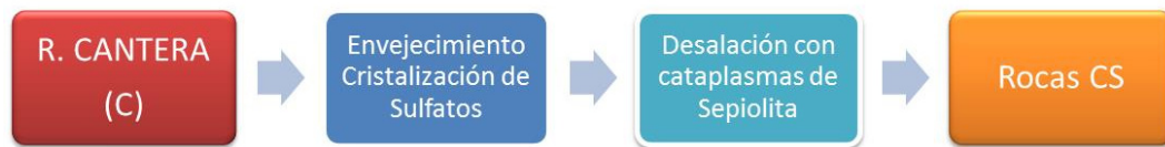
Figura 2.4. Esquema del proceso de obtención de las probetas CS.
