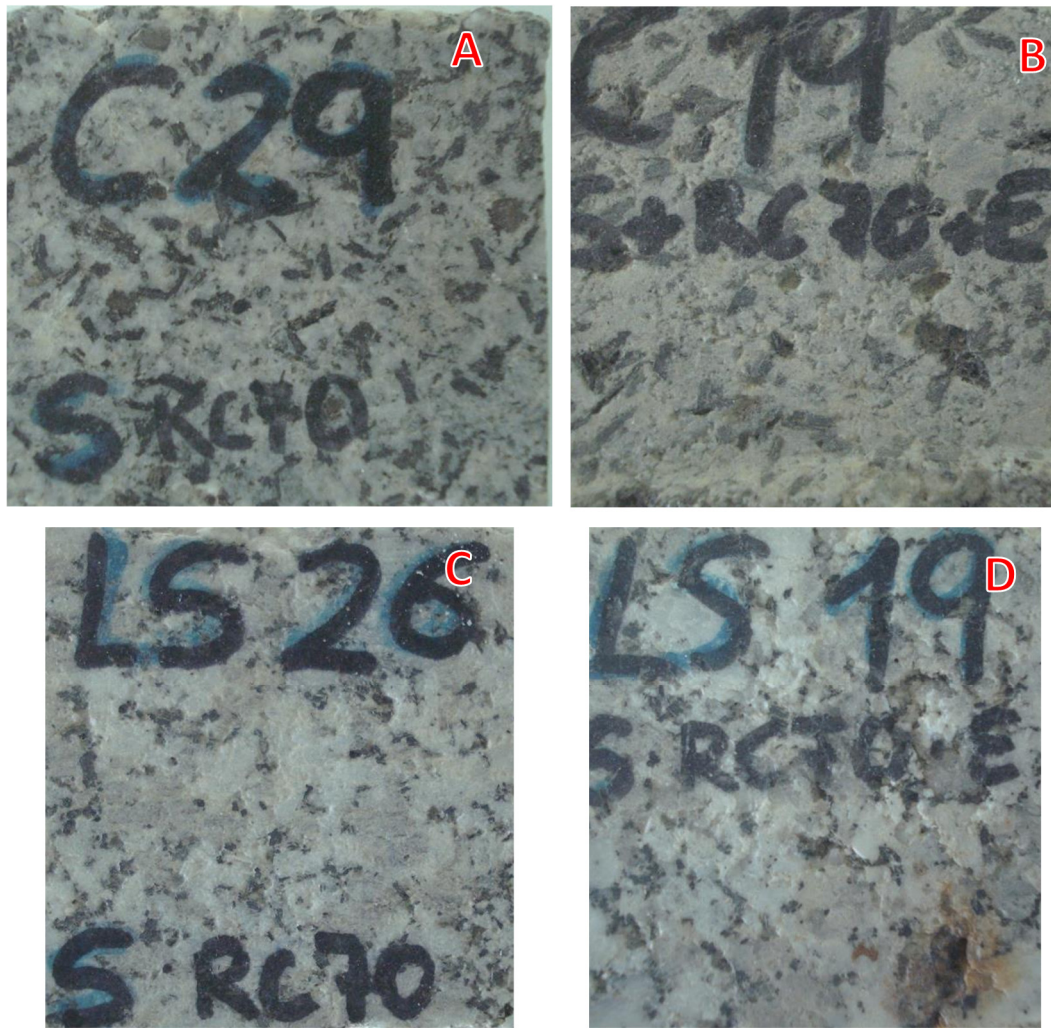
Figura 5.54. Probetas CS tratadas con RC70 (A y C) y después envejecidas por HD (B y D) de Calzadilla y Los Santos, respectivamente.
