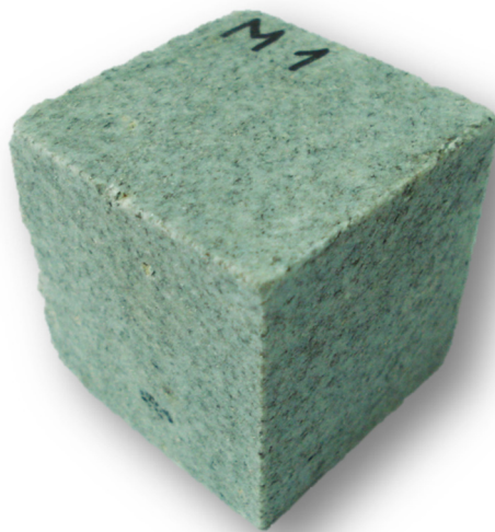
Figura 3.37. Aspecto de visu del leucogranito de Martinamor en una de las probetas empleadas para la caracterización del material.
