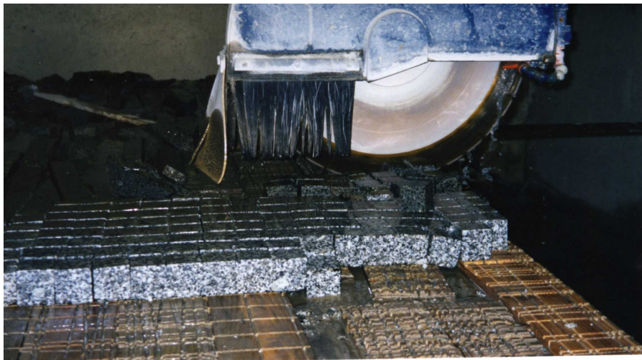
Figura 2.1. Corte de probetas a partir de un bloque grande de granito de Los Santos
