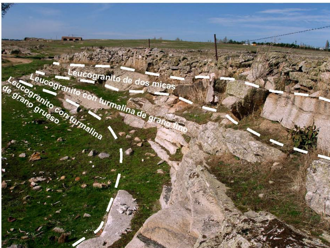
Figura 3.29. Afloramiento de las canteras de Martinamor mostrando la disposición de las tres principales facies graníticas en la parte superior del cuerpo laminar
