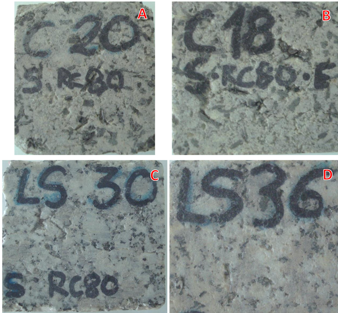
Figura 5.60. Probetas CS tratadas con RC80 (A y C) y después envejecidas por HD (B y D) de Calzadilla y Los Santos, respectivamente.
