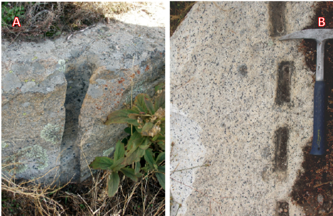
Figura 3.31. Sondeos de sección triangulas en la facies de grano grueso (A) y restos de cuñeras en la facies de grano fino (B)
