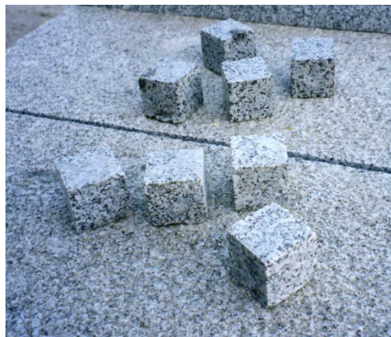
Figura 2.2. Probetas de vaugnerita (al fondo) y de granito de Los Santos (al frente)
