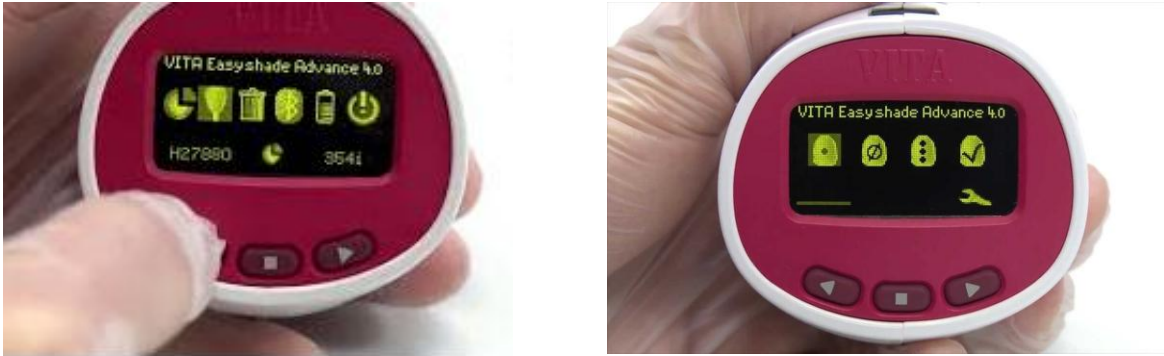
Figura 31. Calibración Manual del Espectrofotómetro.
