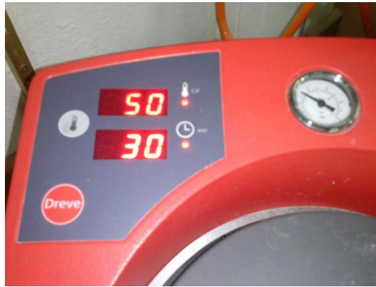
Figura 26. Temperatura en el horno para polimerización de la resina acrílica.
