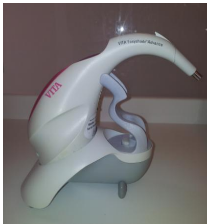
Figura 16. Espectrofotómetro VITA EasyShade Advance . Fuente: Datos propios de la Investigación (Maddia, 2015)
