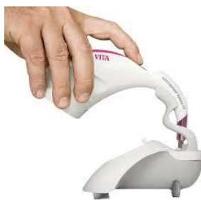
Figura 30. Colocación del aparato para calibración automática del Espectrofotómetro. Fuente: http://www.laboshop.com
