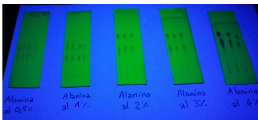
Figura 28. Estudio de la separación de los enantiómeros de la mezcla racémica de receptores 3 por CCF en presencia de cantidades variables de L-alanina.
