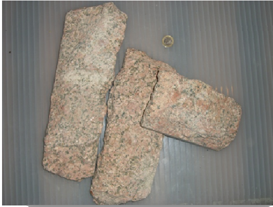
Fig. 8. Muestra de granito Rojo Sayago para los ensayos.
