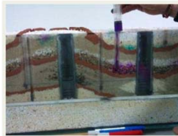
Modelo de acuífero con el que se trabaja en el laboratorio.
