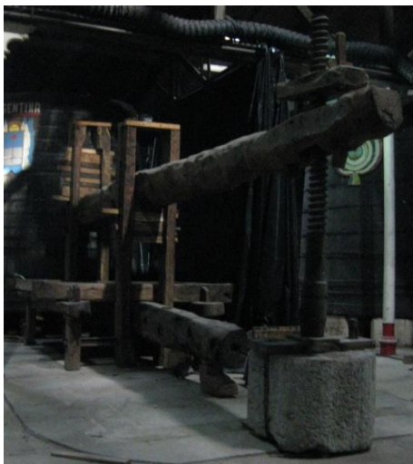
Prensa de pesa. (Cortesía de Valle, Ballina y Fernandez S.A.)
