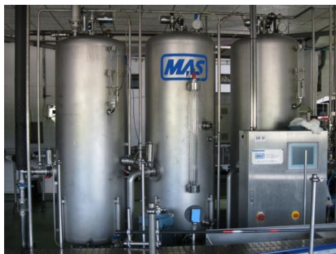
Carbonatadora en columna. (Cortesía de Valle, Ballina y Fernández S.A.)
