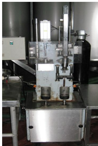
Taponadora y alambradora. (Cortesía de Valle, Ballina y Fernández S.A.)
