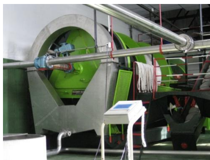
Prensa hidráulica horizontal Bucher-Guyer. (Cortesía de Valle, Ballina y Fernandez S.A.)
