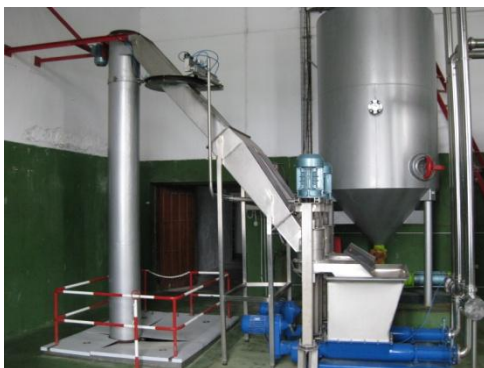
Molino de rejilla. (Cortesía de Valle, Ballina y Fernandez S.A.)
