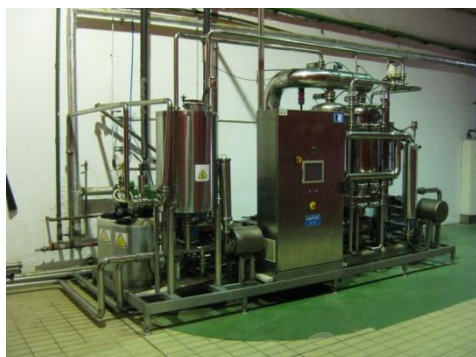
Filtro de tangencial cerámico. (Cortesía de Valle, Ballina y Fernández S.A.)
