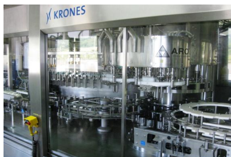
Llenadora-embotelladora isobárica. (Cortesía de Valle, Ballina y Fernández S.A.)
