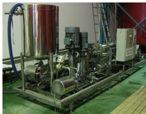
Filtro de ósmosis inversa. (Cortesía de Valle, Ballina y Fernández S.A.)
