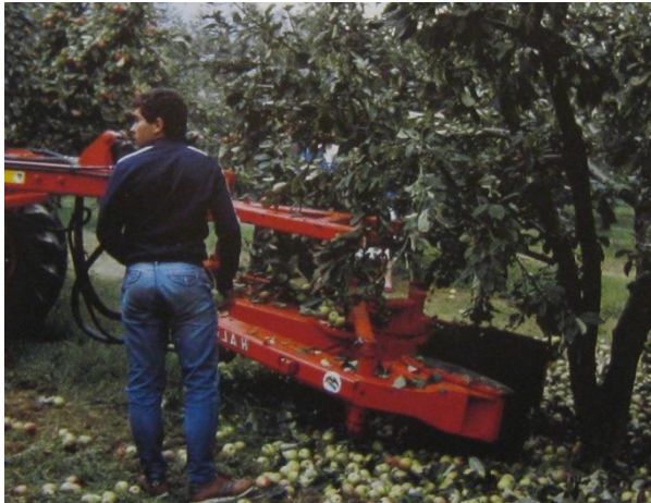
Vibrador accionado por la toma de fuerza del tractor. ( T_1 ).
