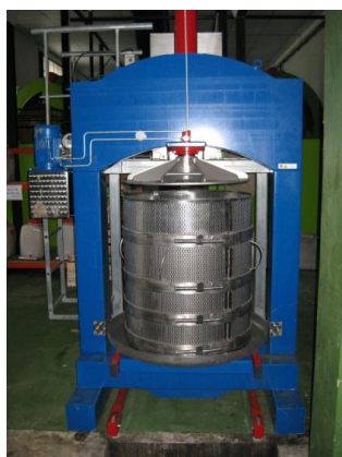
Prensa cilíndrica vertical del husillo simple. (Cortesía de Valle, Ballina y Fernandez S.A.)
