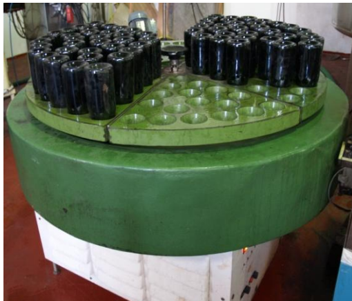
Congelador del cuello de la botella. (Cortesía de Valle, Ballina y Fernández S.A.)
