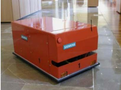
El núcleo del robot o elemento de transporte es un vehículo-chasis con tres ruedas. Está equipado con un motor de 0,13 kW (potencia capaz de impulsarlo por superficies horizontales, pero insuficiente para subir pendientes), y dispone de un ordenador de a bordo y de un panel de mando para servicio local o de emergencia
