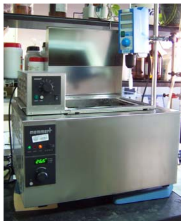
Fig. II.7 Aparato empleado en los ensayos de solubilidad
