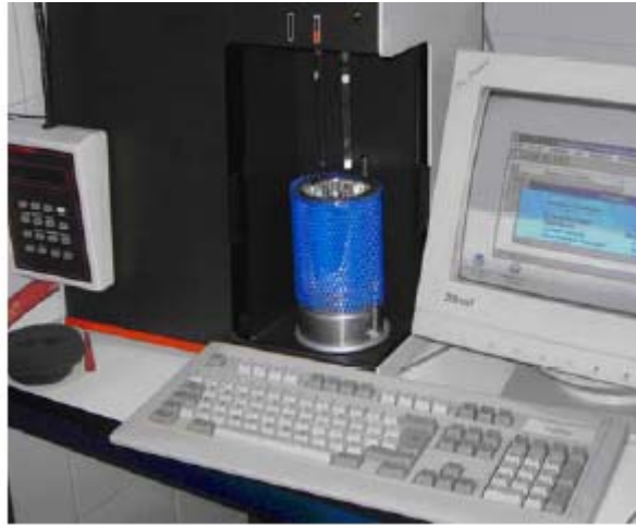
Fig. II.4 Instrumento utilizado en el registro de isotermas de adsorción-desorción de N_2 a -196\text{ }^\circ\text{C}
