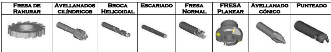
Fig. 2. Identificación de herramientas para fresadora.
