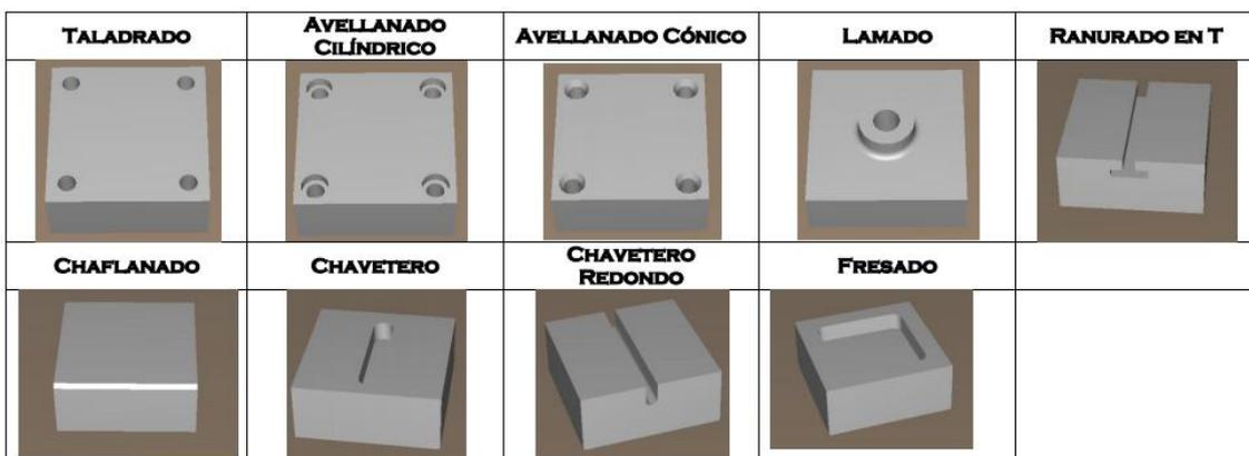
Fig. 3. Identificación de mecanizados simples.
