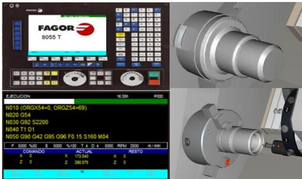
Fig. 8. Mecanizados con torno de control numérico.
