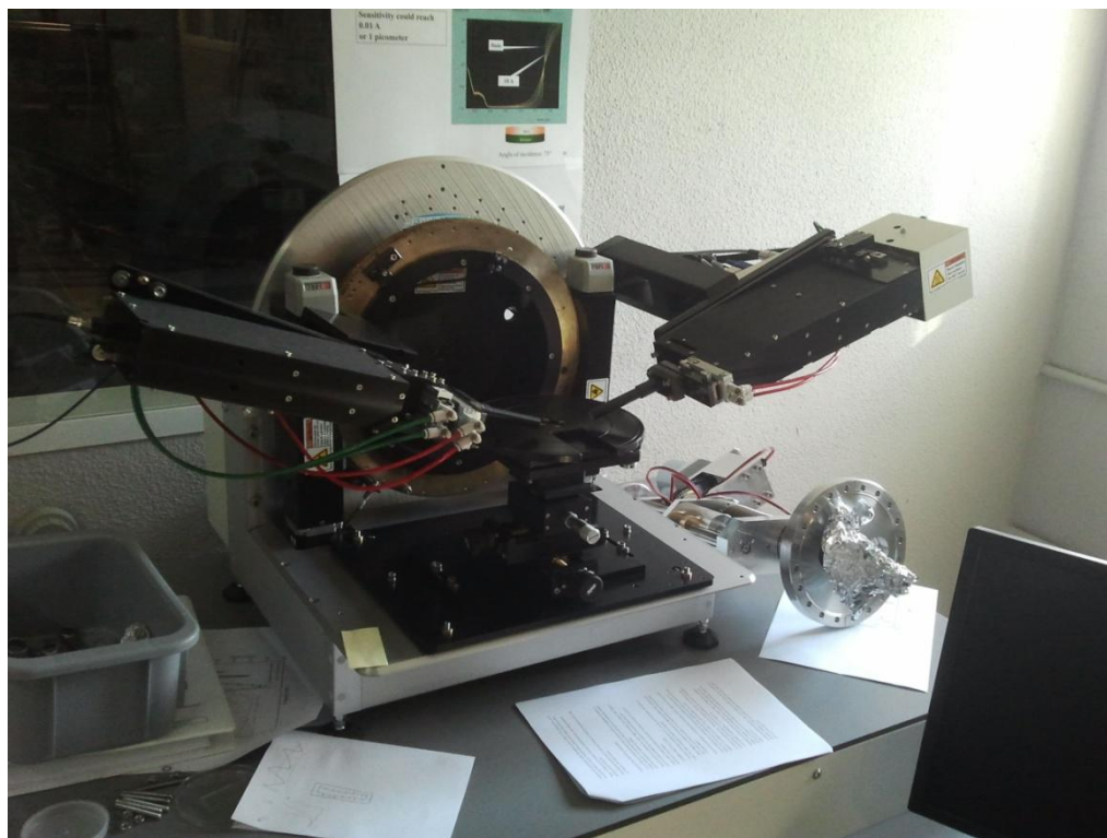
Figura. 3.9. Imagen del elipsómetro SOPRA GES 55..
