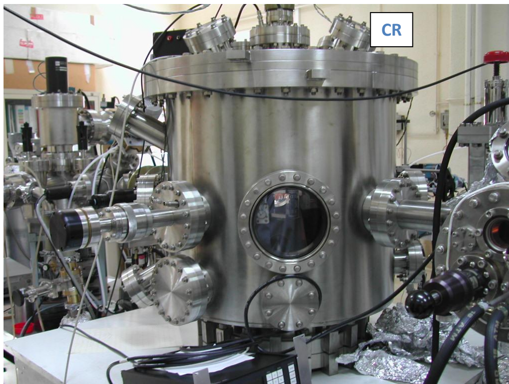
Figura. 3.5. Imagen de la cámara de reflectometría (CR).
