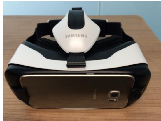
Figura 15.- Gafas de visión estereoscópica, marca Samsung, donde se incorpora un móvil para su visualización
