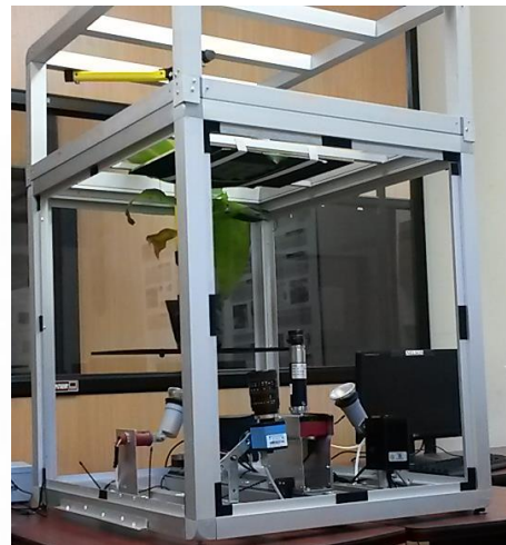
Figura 3.1 Sistema de Imágenes Hiperespectrales.
