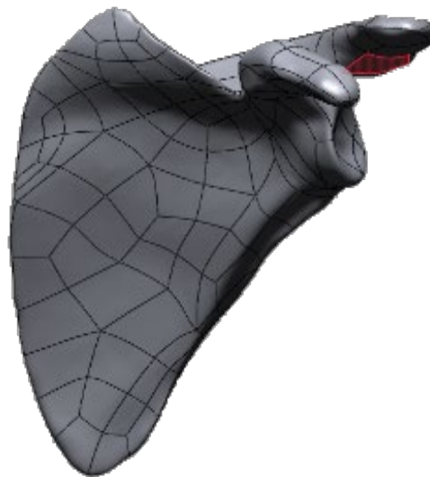
Figura 6. Reconstrucción de la geometría, mediante el software Geomagic Design X, a partir de la nube de puntos asociada a la escapula.
