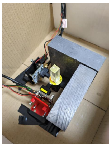
Ilustración 31. Setup experimental dentro de una caja cuyo exterior es de aluminio
