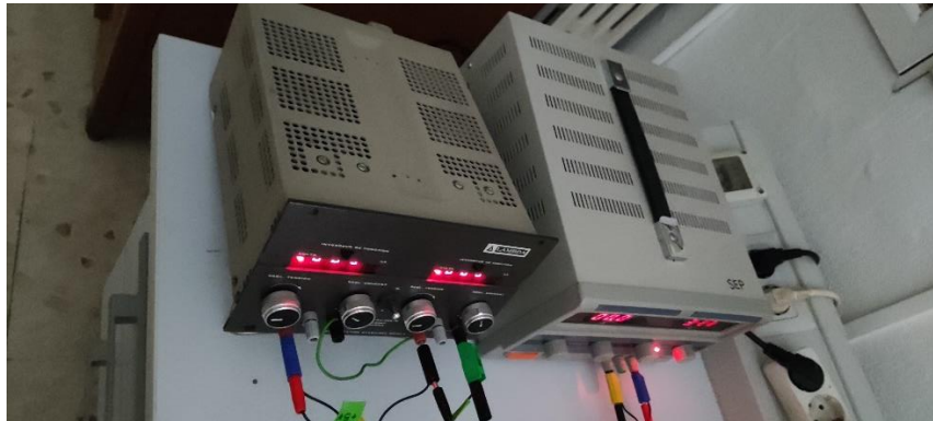
Ilustración 35. Fuentes de alimentación del sistema LYSO-SiPM, posible fuente del ruido.
