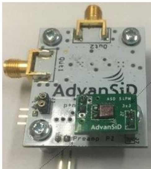
Ilustración 14. Preamplificador AdvanSiD conectado con el SiPM
