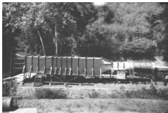
Figura 2.1: Túnel de viento utilizado en los estudios del comportamiento del fuego de Fons [36].
