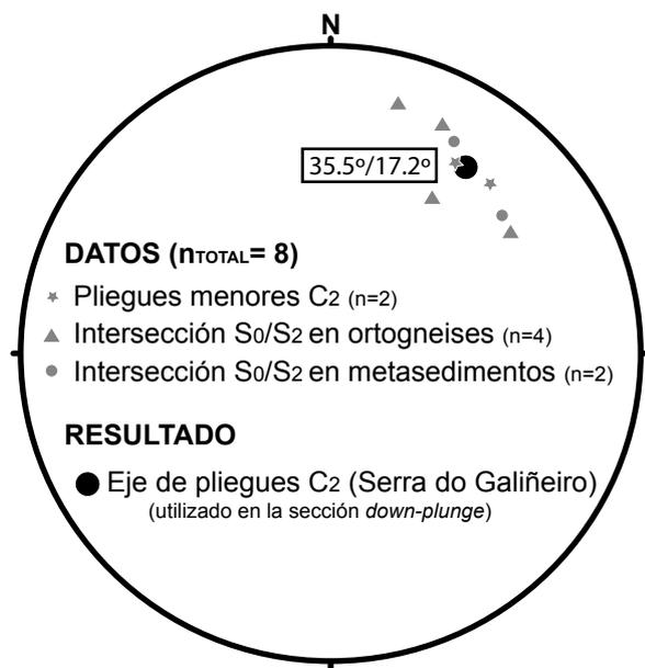
**Fig. 5.4-** Cálculo de la orientación media del eje de plegamiento  $C_2$  en la Serra do Galiñeiro a partir de elementos lineales significativos. Este eje ha sido usado para construir la sección *down-plunge* de la Fig. 5.5.
