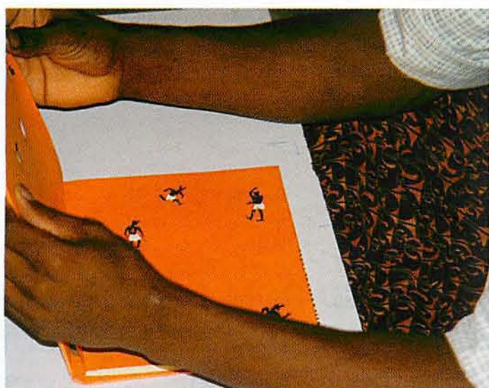
Después el encuadernador encola el lomo de los pliegos a la tapa, y ya está encuadernado el libro.
