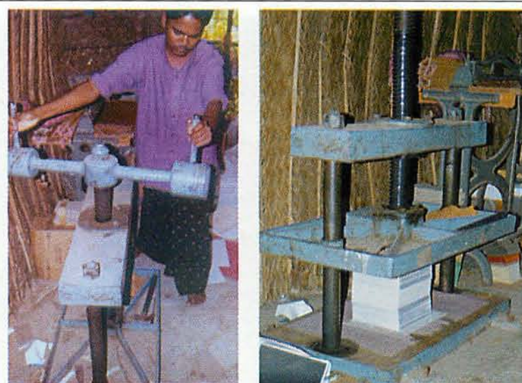
Una vez cosidas, las páginas se prensan para que mantengan la forma plana.
