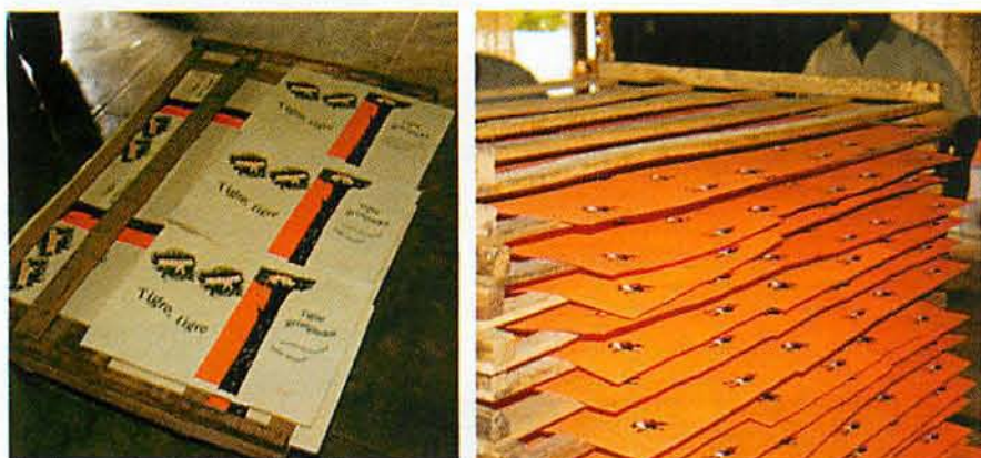
Las páginas todavía frescas se secan sobre palets de madera.
