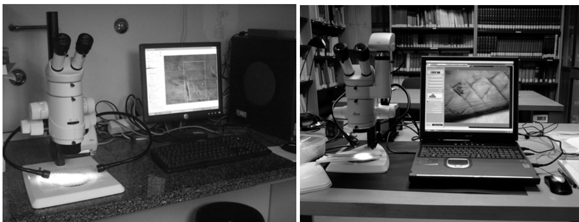
Figura 5.5: Equipo de lupa binocular, cámara y ordenador utilizado por nosotros en el Laboratorio de Prehistoria de la USAL y en el Museo de Prehistoria de Santander (cortesía del Instituto Internacional de Investigaciones Prehistóricas de Cantabria)
