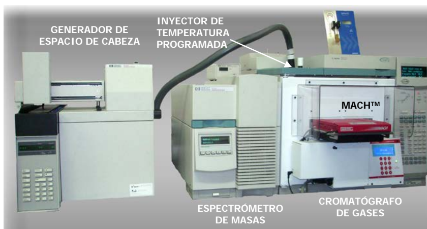
Figura 4: Configuración instrumental HS-PTV-GC-MS con MACH™
