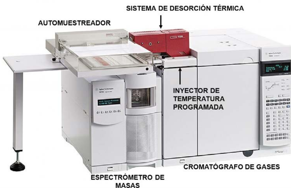
Figura 8: Configuración instrumental TDS-PTV-GC-MS
