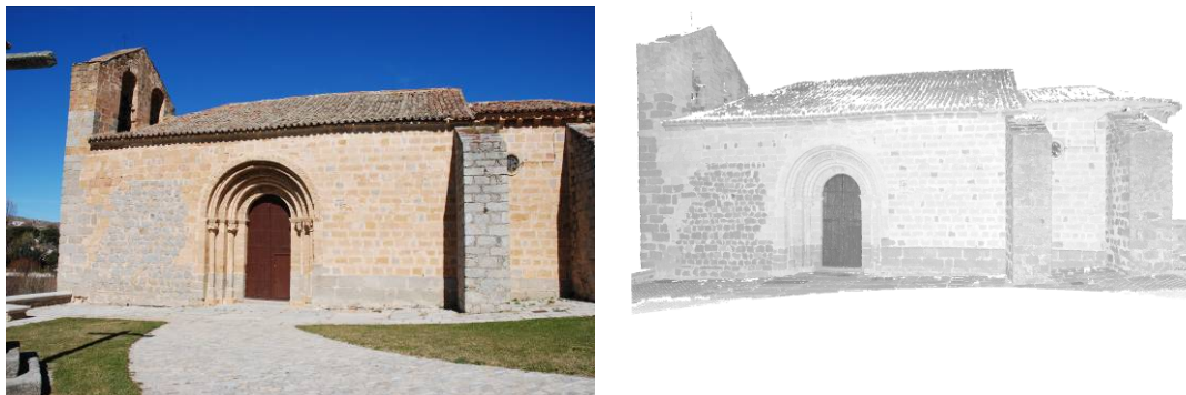
Figura 6.71 Datos de entrada. Izquierda: Imagen procedente de la cámara. Derecha: Imagen de rango procedente del láser escáner
