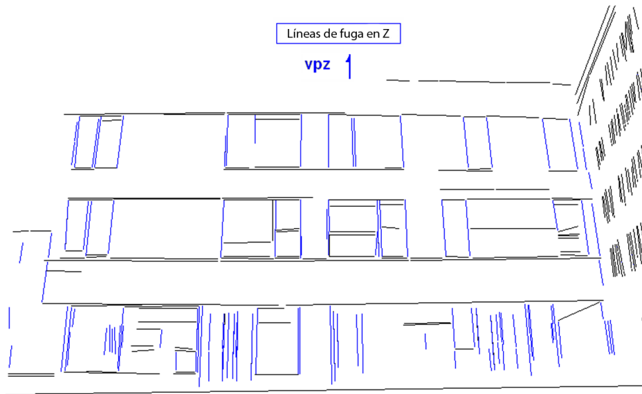
Figura 6.47 Mini-segmentos extraídos de la imagen mediante el software sv3Dvision
