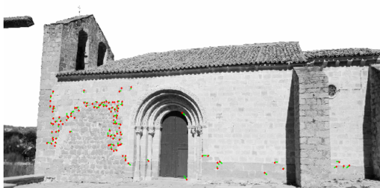
Figura 6.74 Error de reproyección en píxeles con un factor de aumento (x10) sobre la imagen de alta resolución
