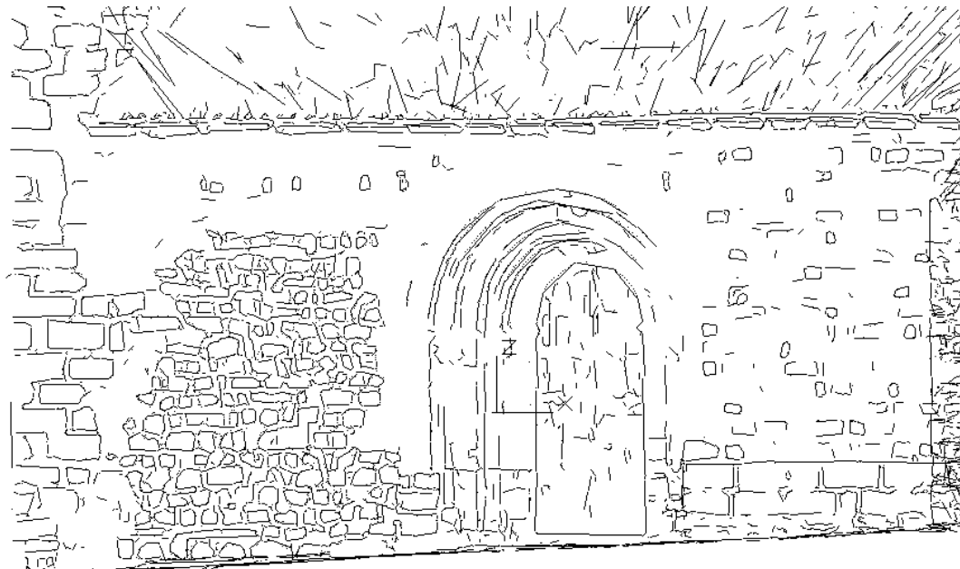
Figura 6.81 Detalle de los elementos lineales de la fachada románica para Canny con \sigma=2
