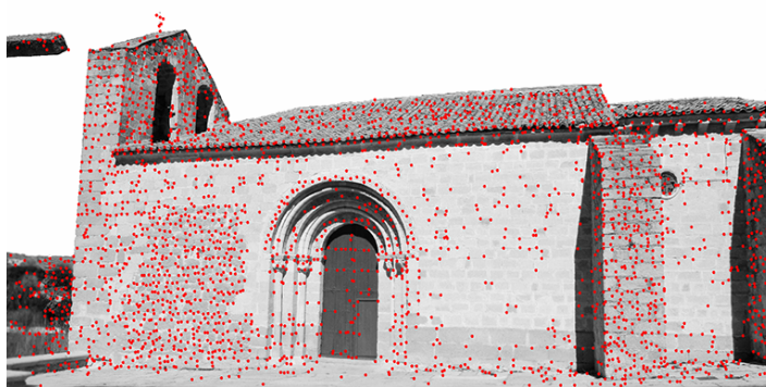
Figura 6.72 Puntos de interés obtenidos mediante el detector de Förstner sobre la imagen de alta resolución
