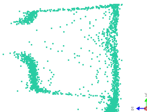
Figura 6.41 Vista de perfil de un cubo "roto" por la alta reflectividad (nº2 de 80mm) con el láser Trimble GX a 30 metros
