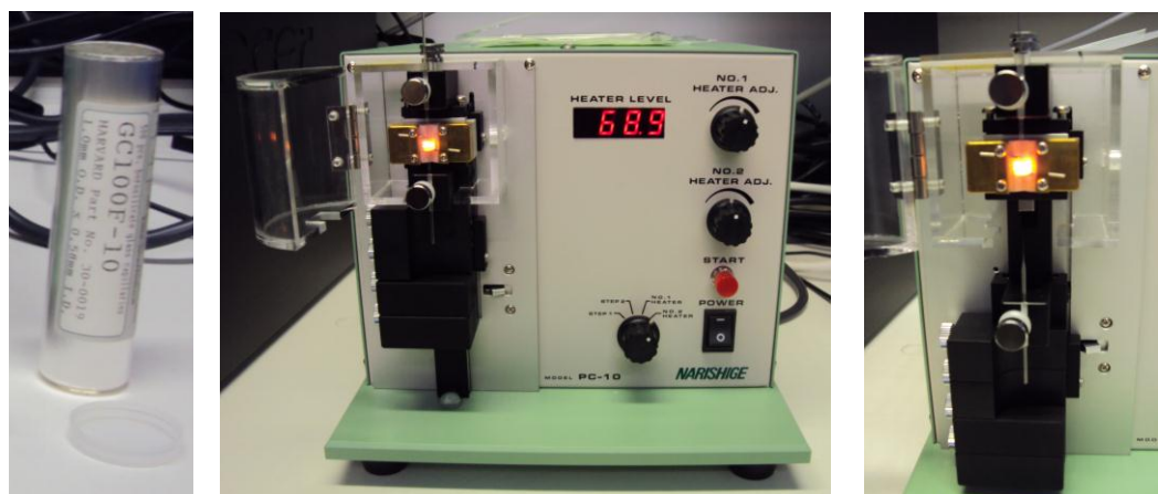
Fig. 29. Los microcapilares que empleamos para la microinyección de los morfolinós y DNA fueron realizados empleando el Puller (Narishige). A la izquierda se muestra los capilares de cristal, al centro se aprecia el Puller en funcionamiento y a la temperatura de 68,9°C la resistencia alcanza el punto en que corta en dos el capilar de vidrio gracias a la ayuda de la fuerza de la gravedad. A la derecha se ve como el capilar de vidrio queda dividido en dos y cada uno presenta un extremo muy alargado y estrecho que tiene la forma de una microaguja.
