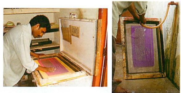
Las planchas usadas para imprimir se han fabricado a partir de un fotolito.
