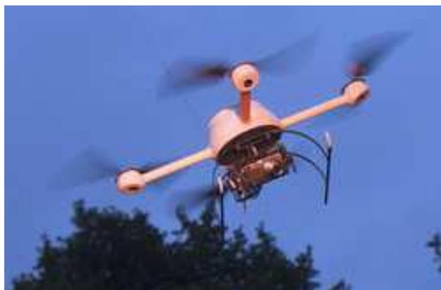
Figura 6- Microdrones utilizado para fotogrametría
