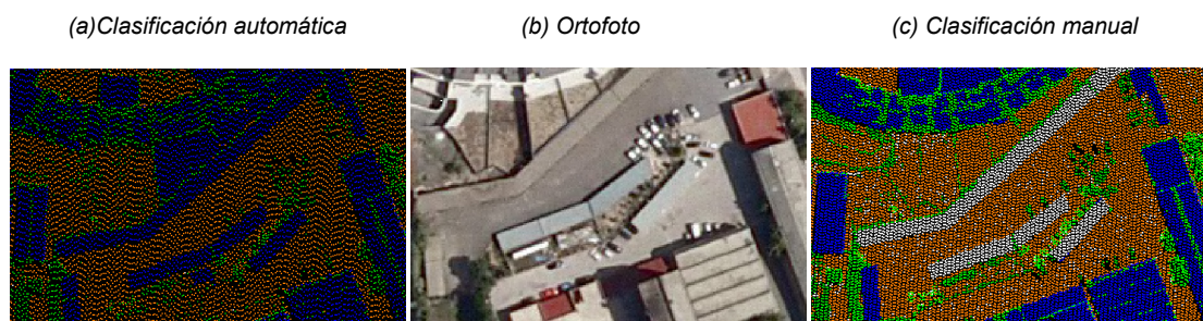
Fig. 23 Aparcamientos cubiertos y patios, clasificados como edificios
