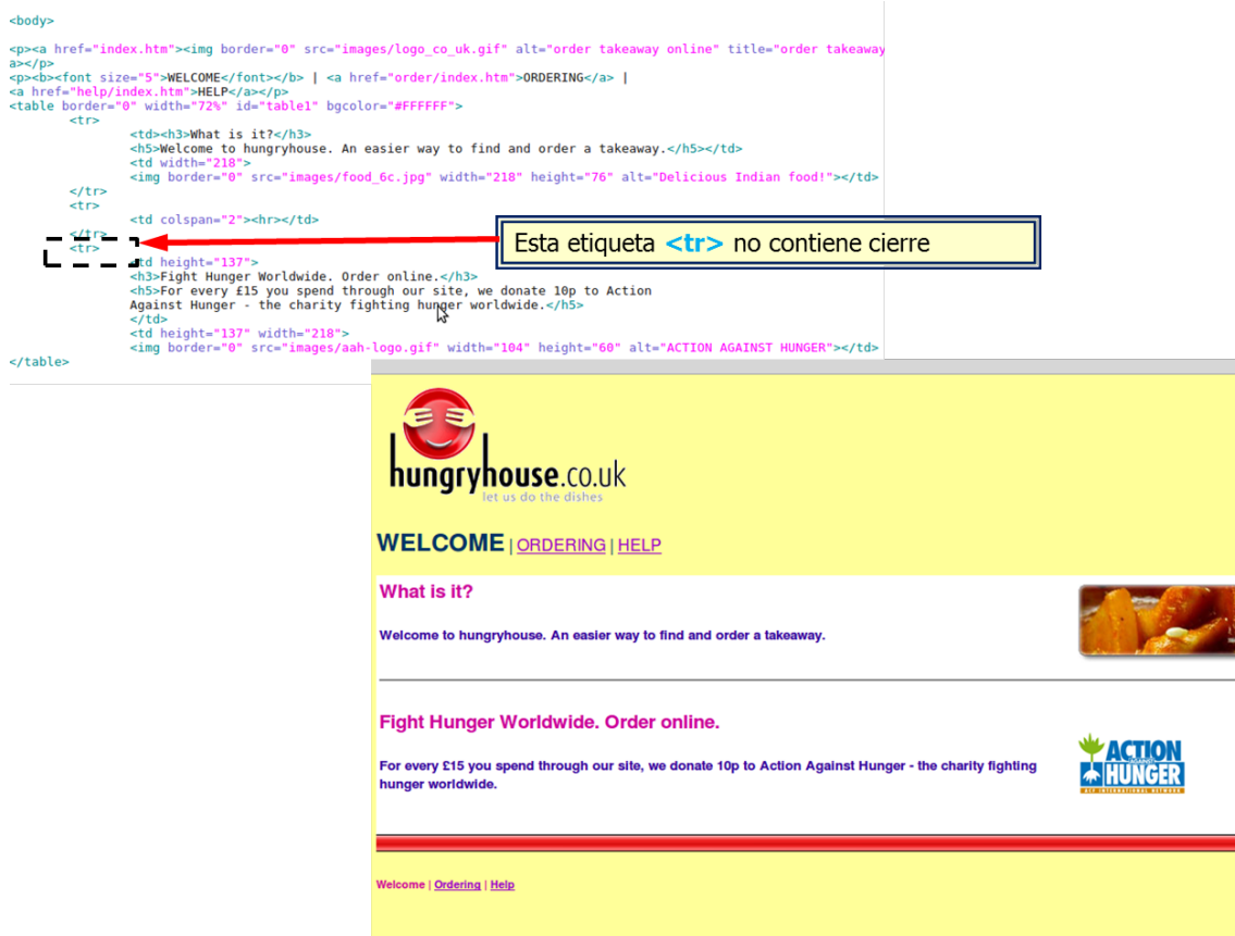
Figura 2.9: Código fuente HTML de un documento con una etiqueta sin cierre y, pese a ello, su interpretación en un navegador.
