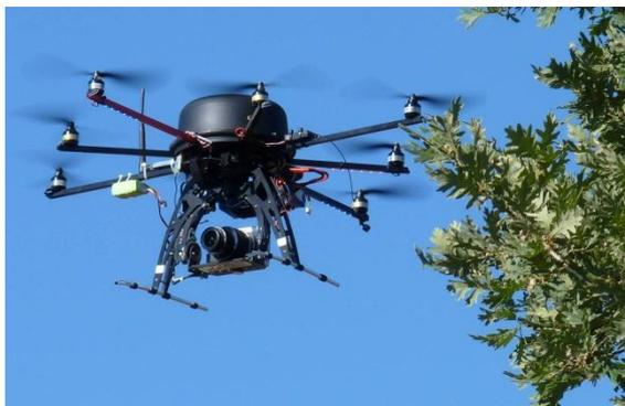
*Figura 5. UAV multirrotor en vuelo*
