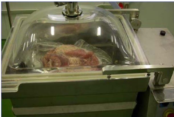
Figura 15. Realización de vacío en el pernil en una amasadora-mezcladora.
