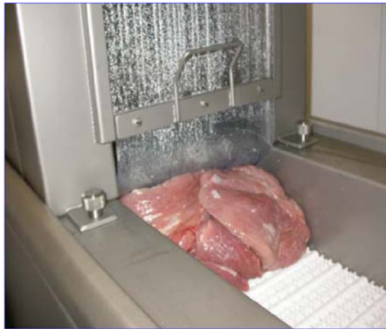
Figura 13. Inyección de la salmuera en una inyectora multiagujas.
