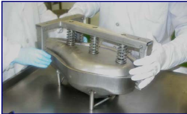
Figura 10. Molde regulable para el enmoldado del pernil.
