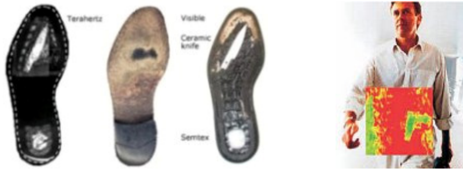
Figura 3. Tecnología de THz para la detección de armas y explosivos.
