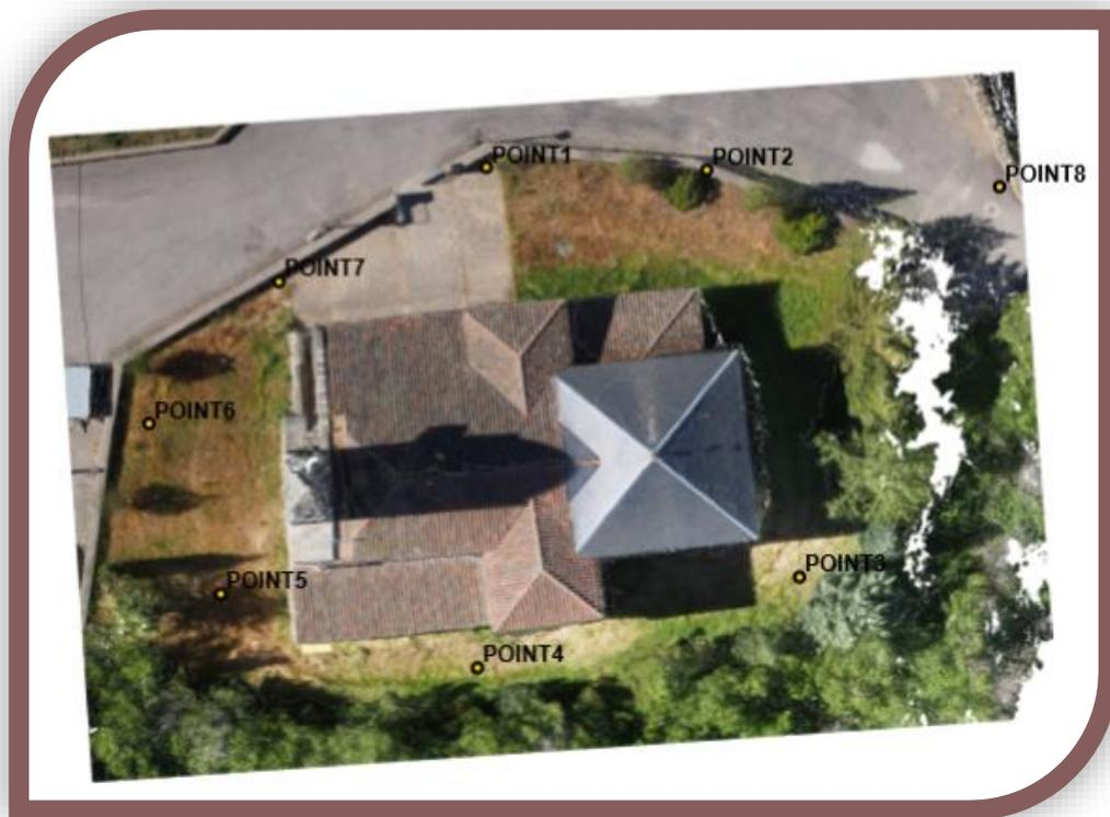
**Ilustración 38. Localización puntos de apoyo**
