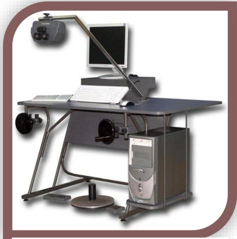
**Ilustración 14. Restituidor digital.**
