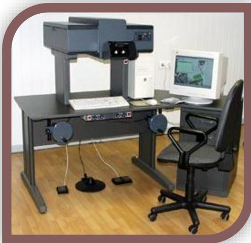
**Ilustración 13. Restituidor analítico.**
