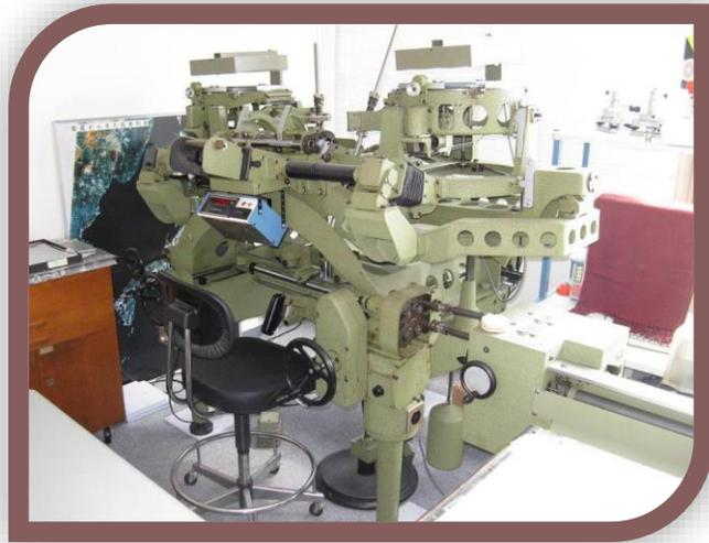
**Ilustración 12. Restituidor analógico.**
