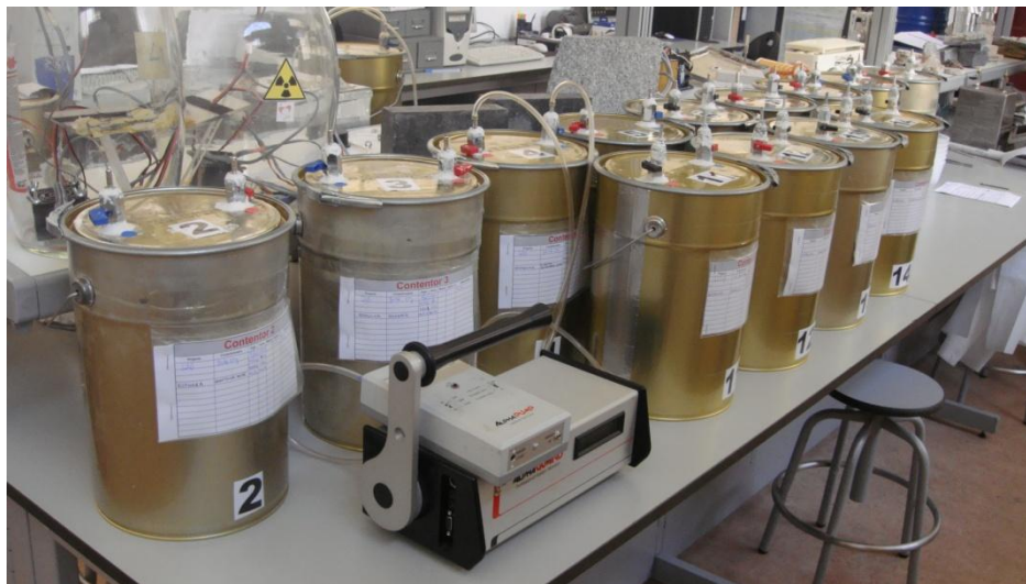
Figura. 18. Medición de cada contenedor con el equipo Alphaguard 2000 Pro
