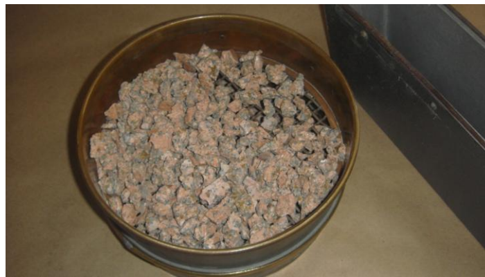
Figura 23. Tamizado < 4\text{mm} de la muestra.
