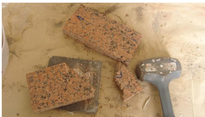
Figura 21. Fraccionamiento de la placa con ayuda de martillo
