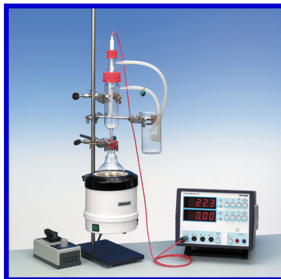
Figura 2: Equipo de ebulloscopia
