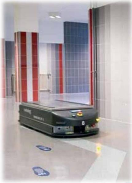
**Figura 1.3:** AGV Transcar de la empresa Swisslog-Telego <sup>4</sup>.
