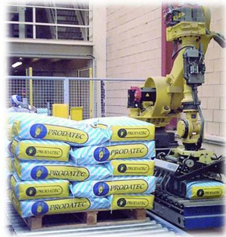
**Figura 1.2:** Robot paletizador P6 de la marca PMI <sup>3</sup>.
