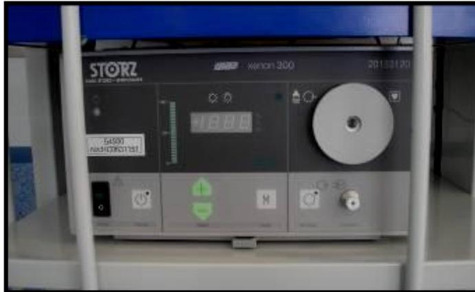
Figura 13. Fuente de luz de xenón de 300W.
