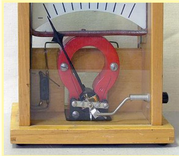
**Figura 6:** Galvanómetro *de demostración*. Imagen bajo licencia *Creative Commons*, reproducida a través de *Wikipedia*<sup>30</sup>.
