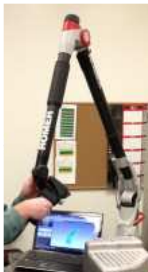
Figura 7. Escaneado brazo robótico
