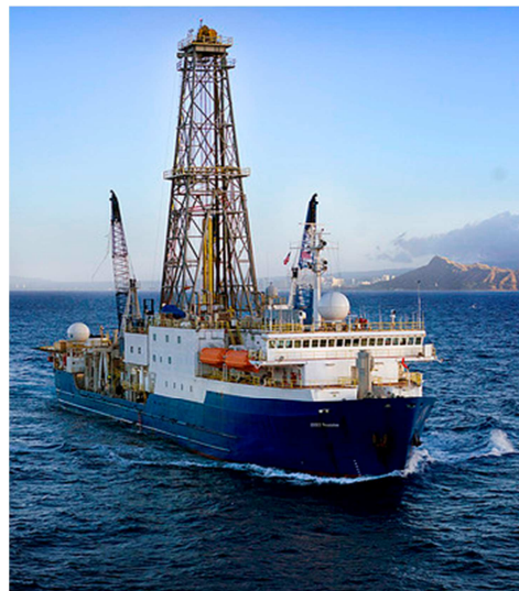
Figura 3.1. Buque de perforación JOIDES Resolution , del Ocean Drilling Program (ODP). Fuente: http://iodp.tamu.edu .
