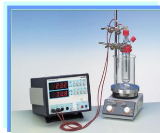
**Figura 4:** Equipo de ebulloscopía
