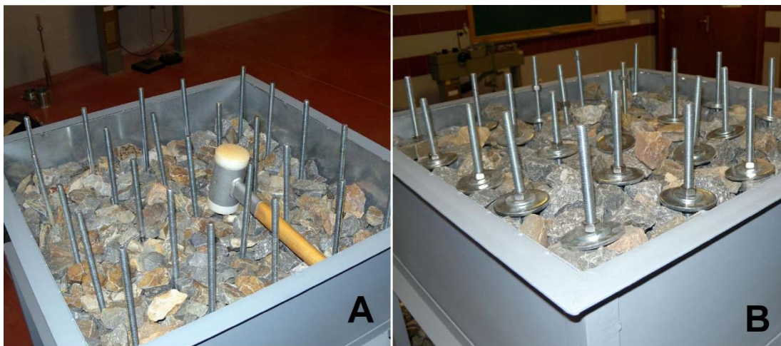
Figura 8. A) Relleno y compactación. B) Colocación de arandelas y tuercas.
