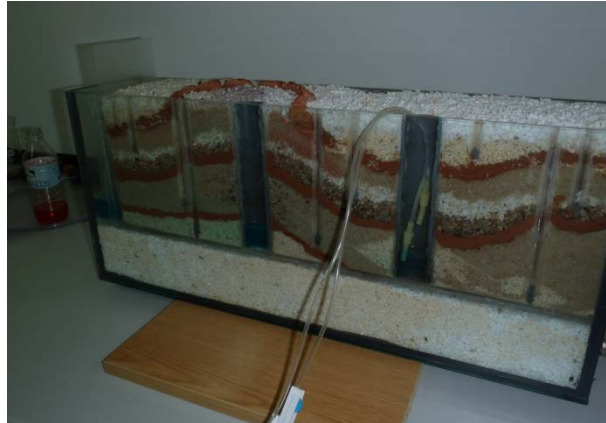
d)Detalle del laboratorio de la EPS de Ávila preparado para mostrar a los estudiantes el comportamiento del agua en el subsuelo.
