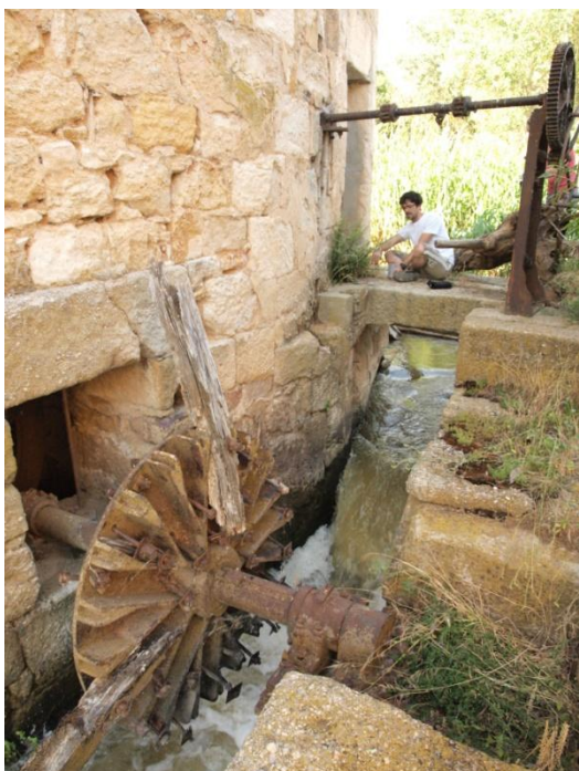
FIG.3.1.2. Restos de la noria, rueda vitrubiana y eje horizontal del molino.
