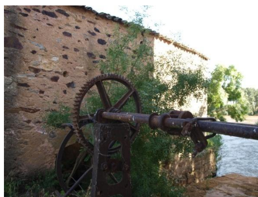
FIG.3.1.3. Antiguo engranaje de accionamiento de las compuertas del aliviadero.
