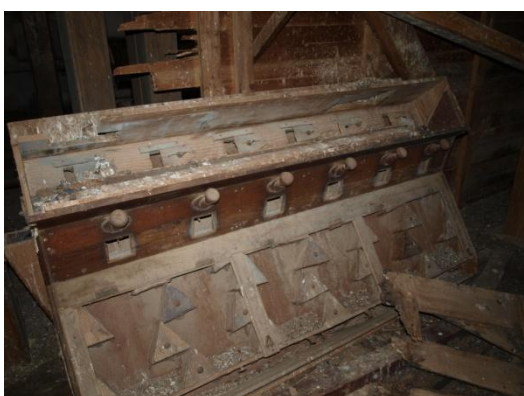
FIG.3.1.9. Maquinaria para la criba y el cernido del material.
