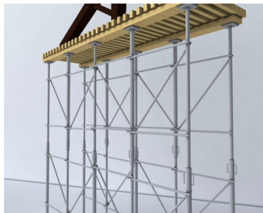
FIG.1.5.2.3. Representación del fuerte arriostramiento de las cerchas de la aceña.
