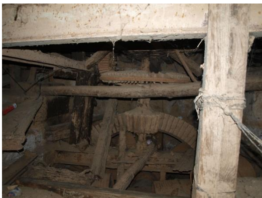
FIG.3.1.4. Sistema de engranaje de linterna para cambiar el movimiento vertical de la rueda en el horizontal de la piedra.
