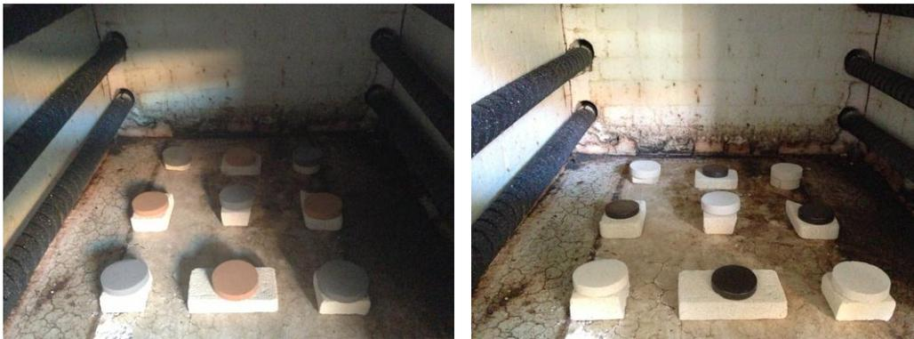
Figura 53. Piezas de ladrillo y paval en verde (izq.); Piezas de ladrillo y paval tras el sinterizado (dcha.).
