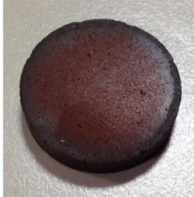
Figura 79. Aspecto de la pieza L98FL2 a la temperatura de 1125°C durante el pulido.
