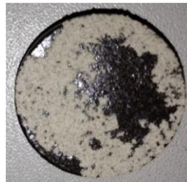
Figura 76. Pieza sinterizada con restos de paval adheridos en su base.
