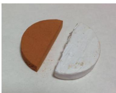
Figura 45. Mitad de la pieza con pintura impermeabilizante.
