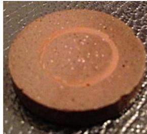
Figura 107. Pieza L98FL2\_1200 con su pista de desgaste.
