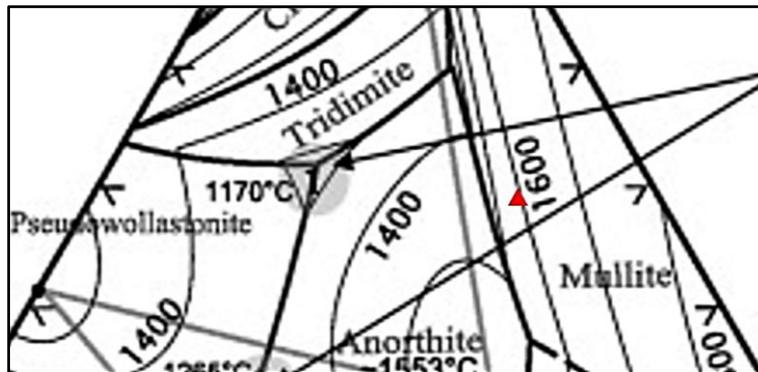
Figura 29. Detalle de la zona donde se sitúa el triángulo de reparto del diagrama ternario  $\text{SiO}_2\text{-CaO-Al}_2\text{O}_3$  de 98% de ladrillo y 2% de escoria de soldadura o flux.
