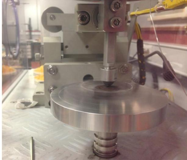
Figura 58. Pin sobre la pieza realizando la pista de desgaste durante el ensayo.
