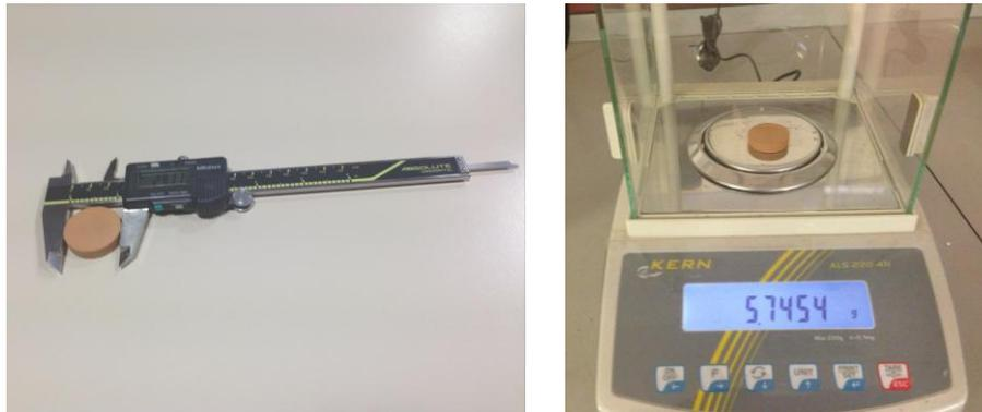
Figura 49. Medida de pieza con calibre digital (izq.); Pesada de la pieza en báscula de precisión (dcha.).
