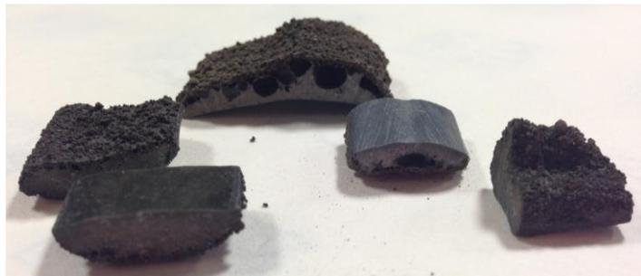
Figura 31. Trozos de escoria de soldadura.
