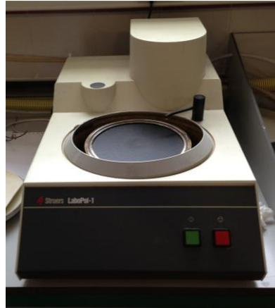
Figura 54. Pulidora automática con lija de carburo de silicio.
