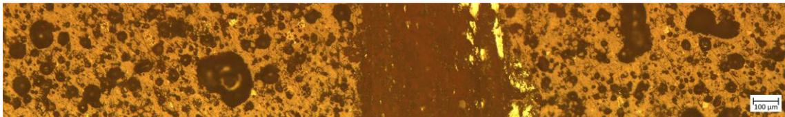
Figura 120. Barrido microscópico de la pista de desgaste L95FL5\_1200.
