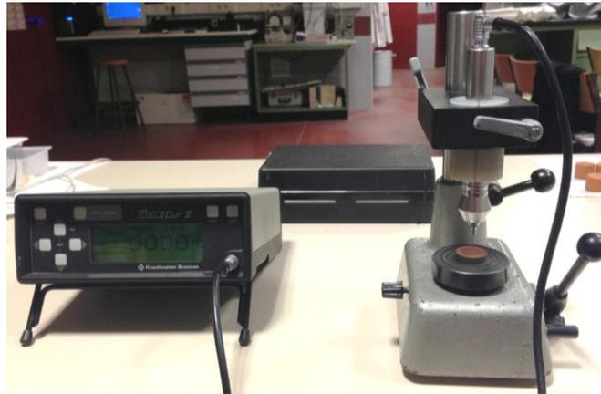
Figura 62. Durómetro.
