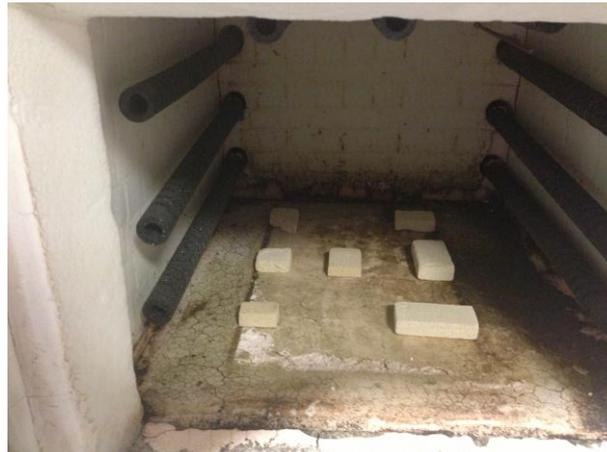
Figura 51. Piezas de pavas colocadas dentro del horno.
