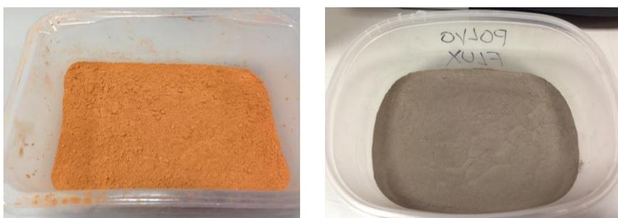
Figura 36. Polvo de ladrillo y escoria de soldadura después de realizar el tamizado (izq. dcha.).
