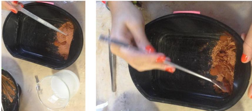
Figura 40. Vertido de la disolución de almidón (izq.); Mezcla de los polvos mediante la espátula (dcha.).
