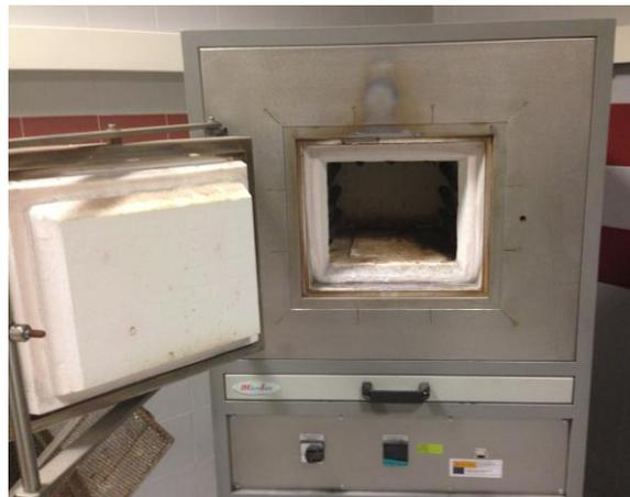
Figura 50. Horno para el sinterizado de las piezas.
