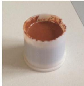
Figura 41. Molde de teflón lleno con 13 gramos de mezcla.
