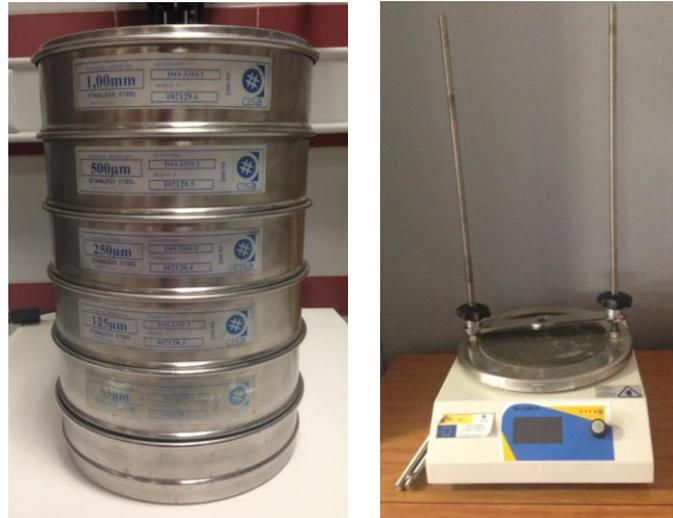
Figura 34. Serie de tamices (izq.); Tamizador (dcha.).
