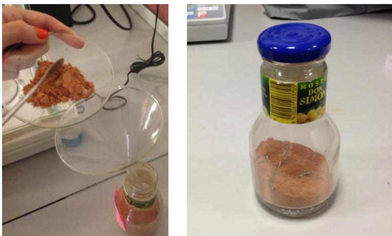
Figura 39. Vertido de la mezcla en el recipiente (izq.); Varillas dentro del recipiente con la mezcla (dcha.).
