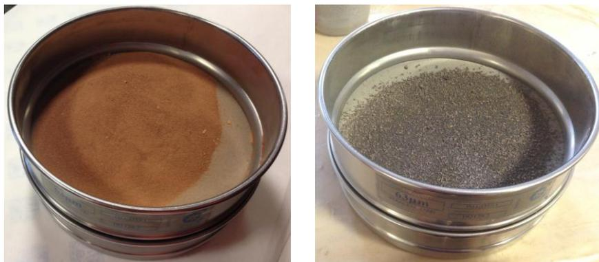
Figura 35. Ladrillo y escoria de soldadura previo al tamizado (izq. dcha.).
