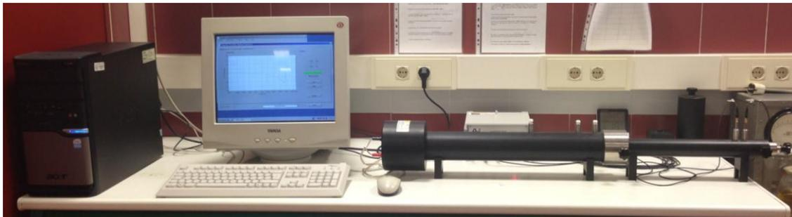
Figura 64. Tubo de impedancia acústica.
