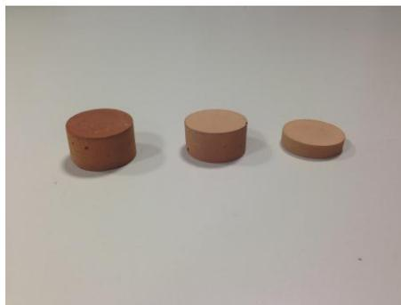
Figura 48. Comparativa de pieza en verde tras el horno de secado, lijada y cortada y lijada.
