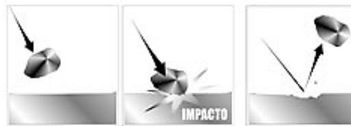
Figura 24. Desgaste erosivo [72].
