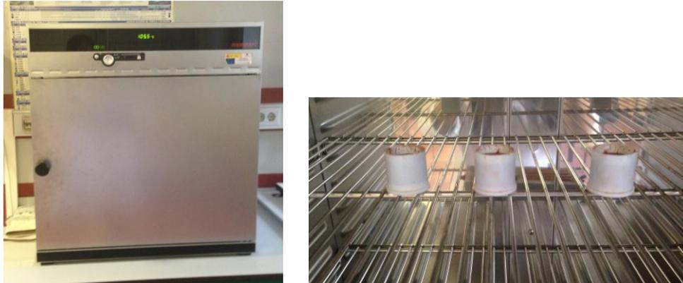
Figura 42. Horno de secado (izq.); Moldes de teflón con la mezcla dentro del horno de secado (dcha.).
