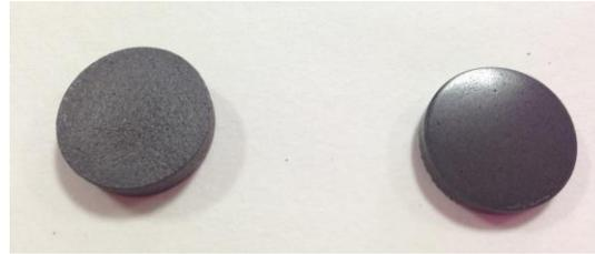
Figura 56. Comparativa de la pieza sin/con desbaste y pulido.
