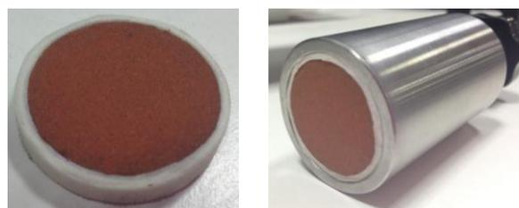
Figura 67. Pieza con esparadrapo (izq.); Pieza dentro del portamuestras (dcha.).
