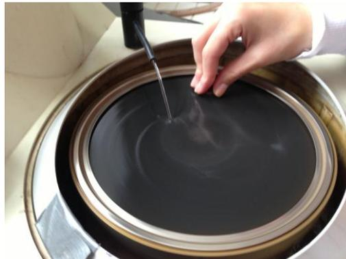
Figura 55. Lijado de la pieza sinterizada.
