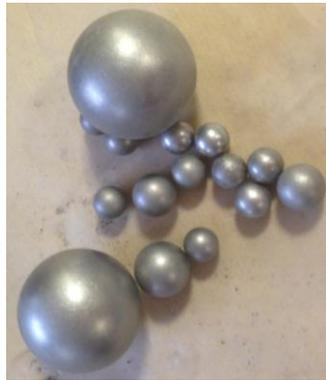
Figura 33. Bolas de acero utilizadas en molienda.
